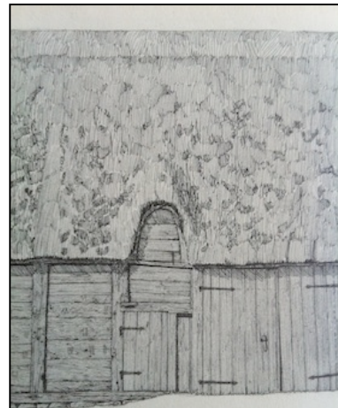
Bild 65. Tyrstrup sn., Danmark. Homejans uppståndare ser ut att ansluta på nedre hälften av takfallet.
