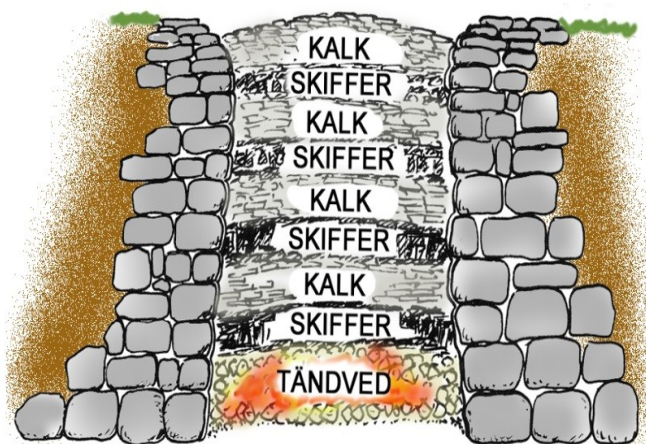
Figur 2. Genomsnitt av kallmurad kalkugn. Länsstyrelsen i Jämtlands län. Årtal okänt
