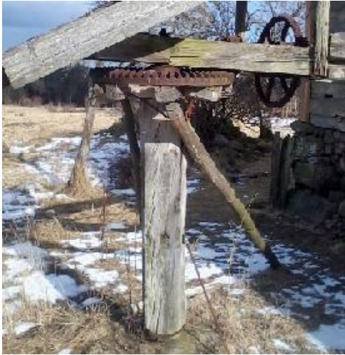
Figur 2. Stående hästvandring, för kraftöverföring från häst till fast maskin. Den står på Äskhults bytomt och visar på kontinuiteten i hästanvändningen. Äskhults by, mars 2013
