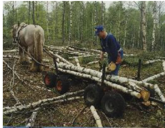
Figur 7. Åtta-hjulig vagn för skogsbruk. Råshult, foto Lars- Ola Borglid.
