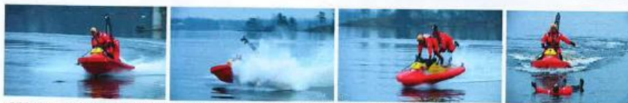
Bildsekvensen visar hur RescueRunnern efter en grundstötning i cirka 20 knop fortfarande är operativ. Detta pga konstruktionen med ett stötabsorberande ytterskrov av polyeten som skyddar den inre kassetten vilken innehåller motor och mekanik.
