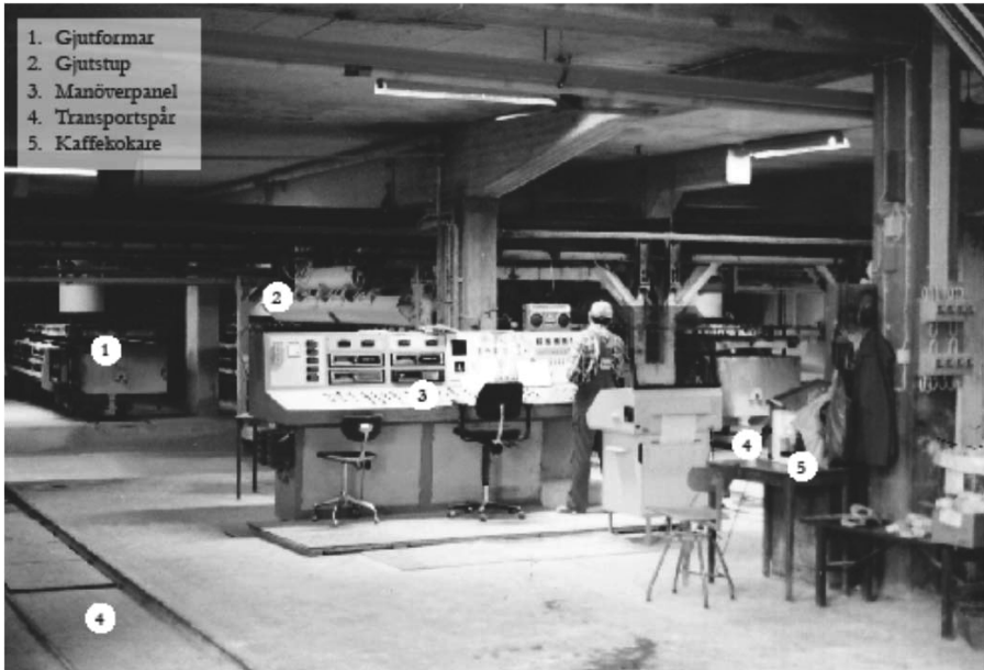
Fotografi 11. Manöverpanelen i gjutstationen, gjutare Leif Johansson, år 1995. Fotograf: Urban Mossberg. Text av Mediakontoret i Norrköping.
