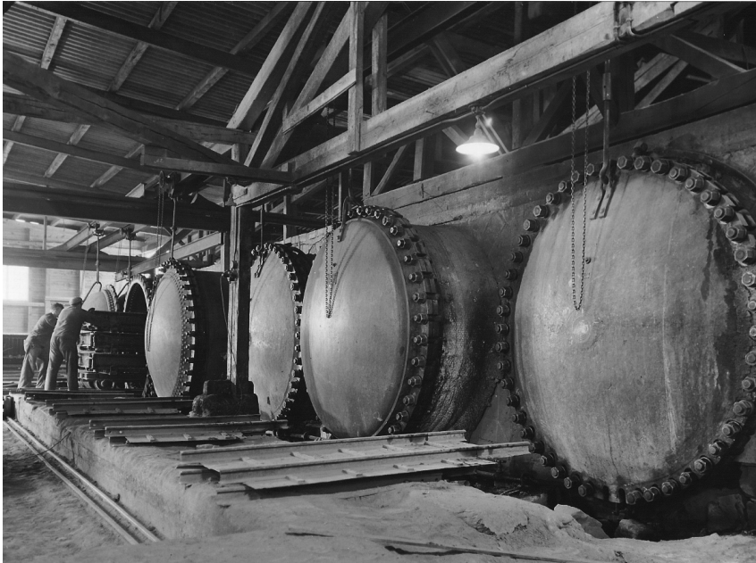
Fotografi 22. Autoklaverna i Norra fabriken, år 1941. Till vänster i bild syns de tre vagnarna staplade ovanpå varandra. Foto: Yxhultbygdens kultur- & hembygdsförening, bildarkiv 202. Fotograf Arne Wahlberg i Stockholm.
