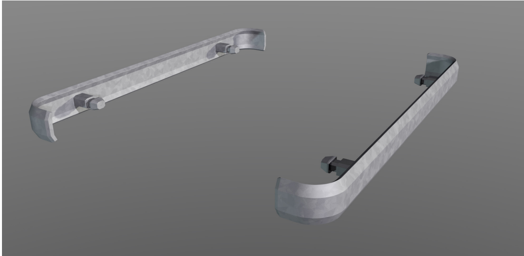
Bild 20, de slutgiltiga sidoskydden, renderade med galvaniserat stål som materialval
