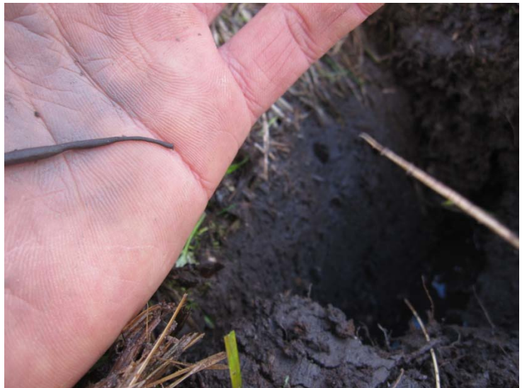
figur 9. Udrulningsprøve af jorden ved prøvested G
