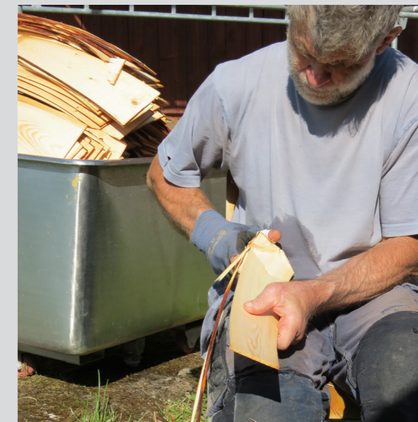
Figur 3.21. Spån med barkrester och vankant skars parallella med kniv.
