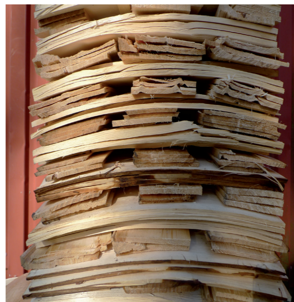
Figur 2.9. Ytterligare ett sätt att stapla spånen för torkning. Här har spånen lagts utomhus och under tak.
