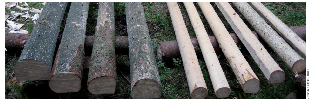
Figur 1.6. Fotografiet visar hur komplext det kan vara att undvika biologisk påväxt. Stockarna är gran, fällda sent i juni och lagrade i skogen. De grövre stockarna till vänster är fulla av ytmögel medan de högra är klenare och saknar mögelpåväxt. En teori är att grövre träd kommer igång tidigare
