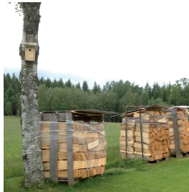
Figur 2.8. Torkningen görs på olika sätt. Här har spånen staplats på högkant och får stå ute under tak och torka.
