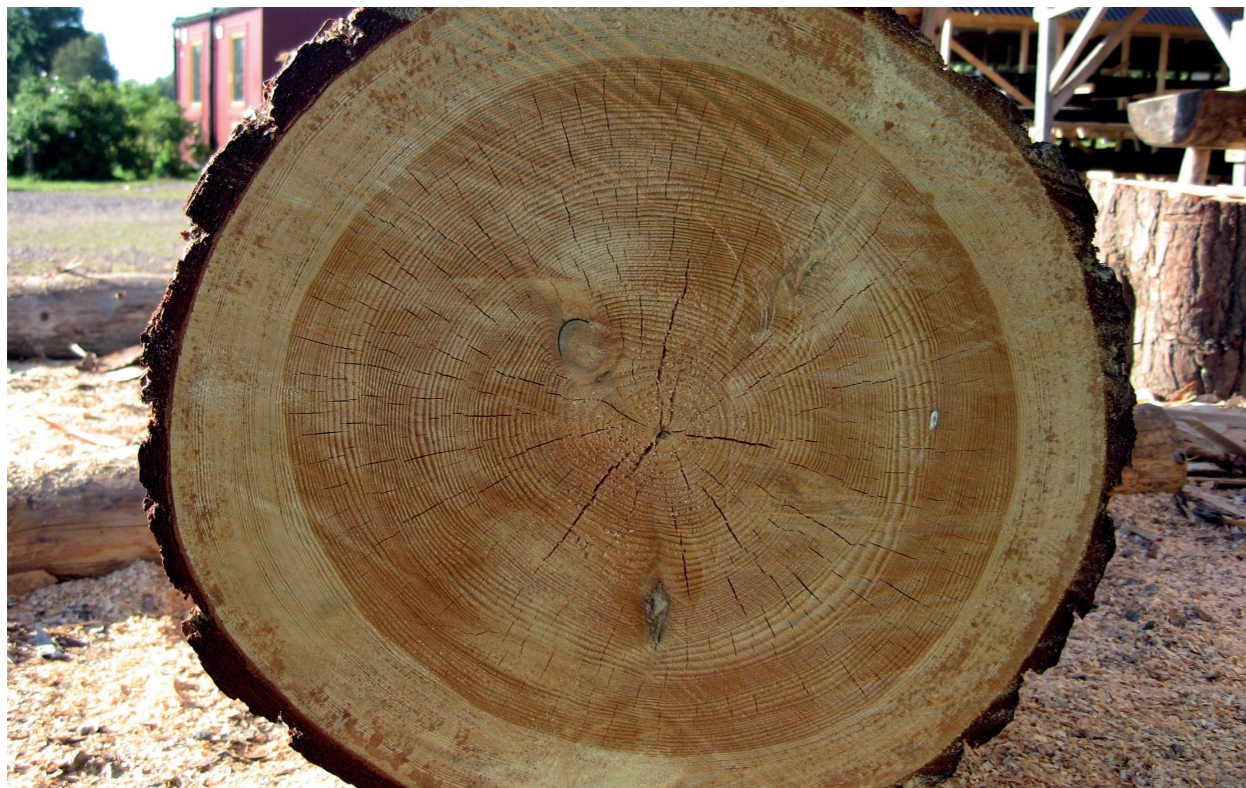
Figur 1.3. Tvärsnitt genom en furu med splint- och kärnved.
