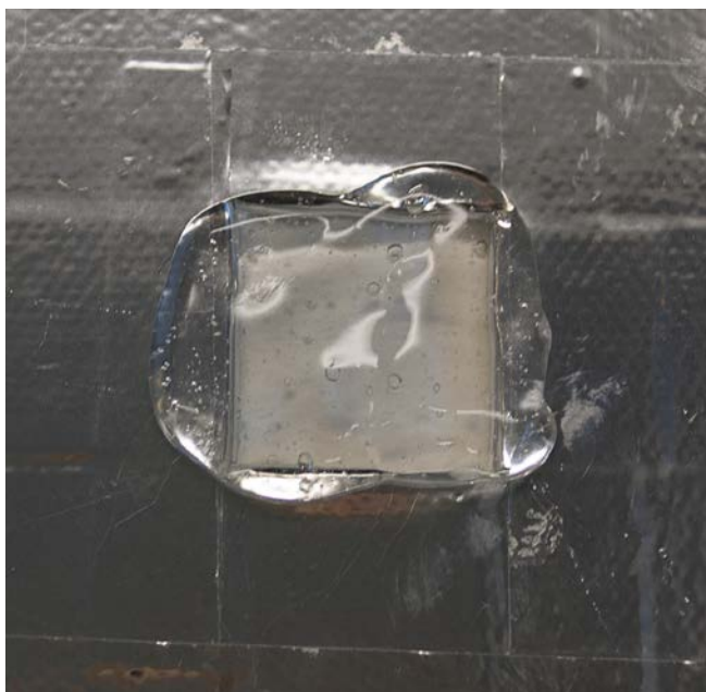
Ovan: Figur 2. PVOH-borax taget med 5x förstoring i arbetsmikroskop.
