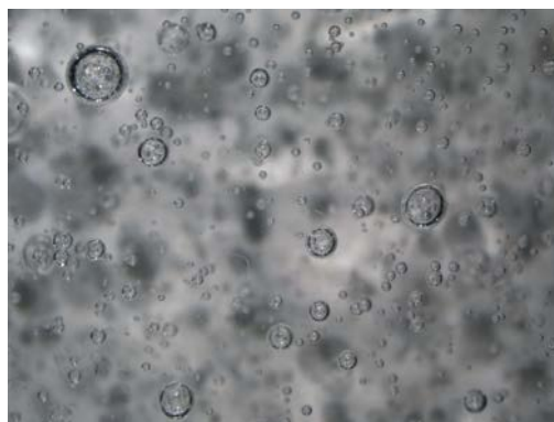
Ovan: Figur 2. PVOH-borax taget med 5x förstoring i arbetsmikroskop.
