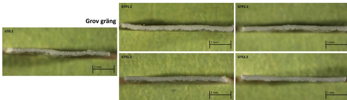
Figur 5. Tvärsnitt, representativt urval från provserie GT (grov gräng, tvärsnitt). Ovansida av tvärsnitten är den preparerade sidan, Urvalet omfattar proverna GT0.2, GTP1.2, GTP2.2, GTS1.1 samt GTS2.2. Foto: A. Schottländer 2014-04-17
