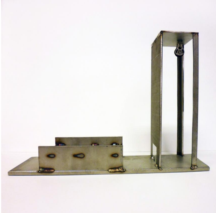
Fig. 1. Riggen Mary ifrån sidan, utan vajer och patron. Riggens dimensioner är ca 250 mm hög x 370 mm lång.
