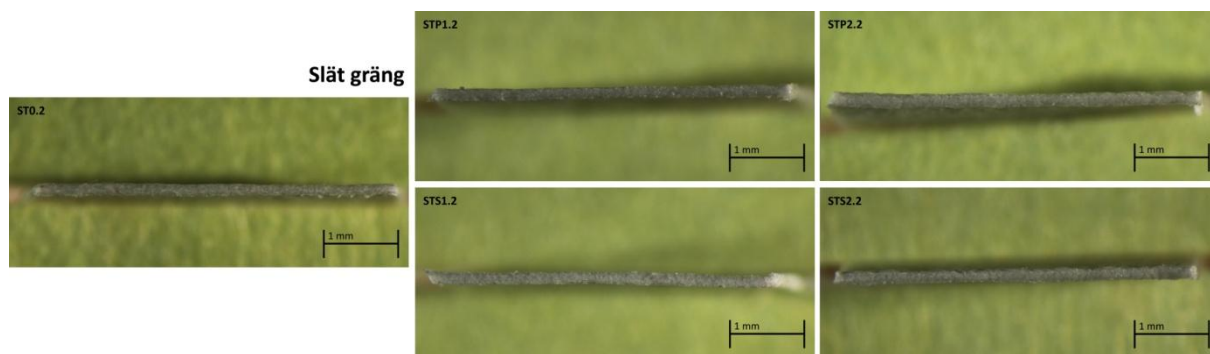
Figur 4. Tvärsnitt, representativt urval från provserie ST (slät gräng, tvärsnitt). Ovansida av tvärsnitten är den preparerade sidan. Urvalet omfattar proverna ST0.2, STP1.2, STP2.2, STS, 1.2 samt STS2.2. Foto: A. Schottländer 2014-04-17
