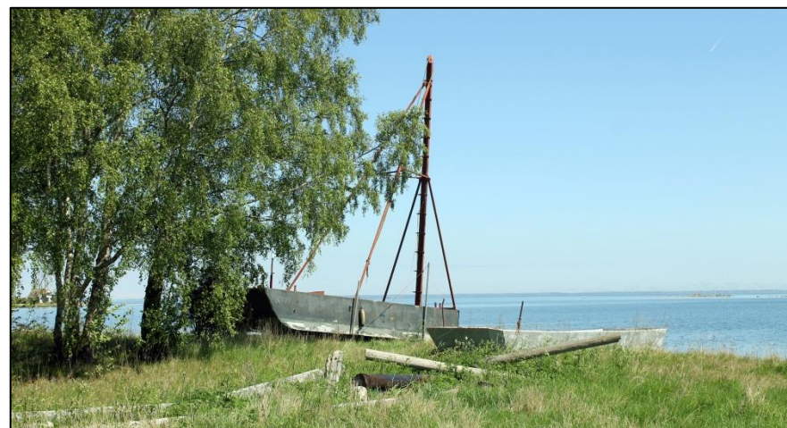
Fig23: Uppdragen pålkran i plåt och en garnpråm.
