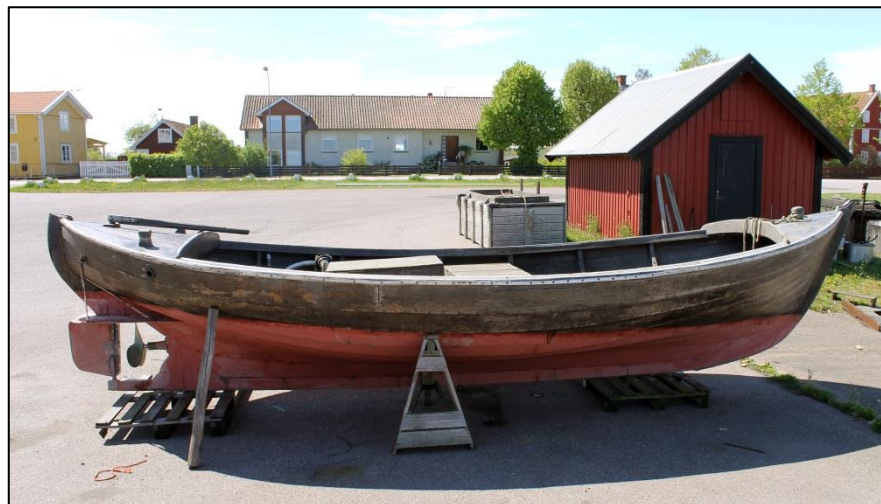
Fig22: Vittjebåt med sump. I bakgrunden syns en stor sump.
