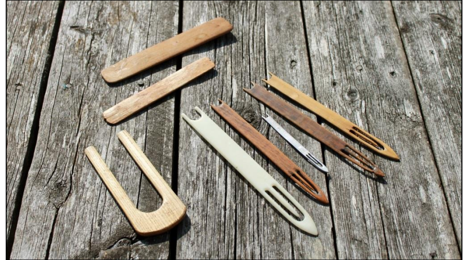
Fig19: Nålar och Skyttlar för garnbindning.
