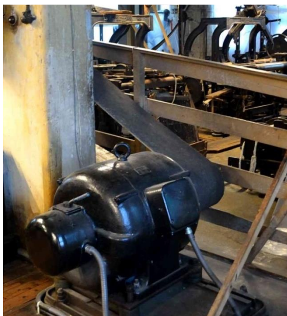
Figur 11. På bilden syns den motor som ursprungligen drev alla remfabrikens maskiner. Hur motorn fungerar och hur den driver maskinerna kan fortfarande demonstreras för besökare.
