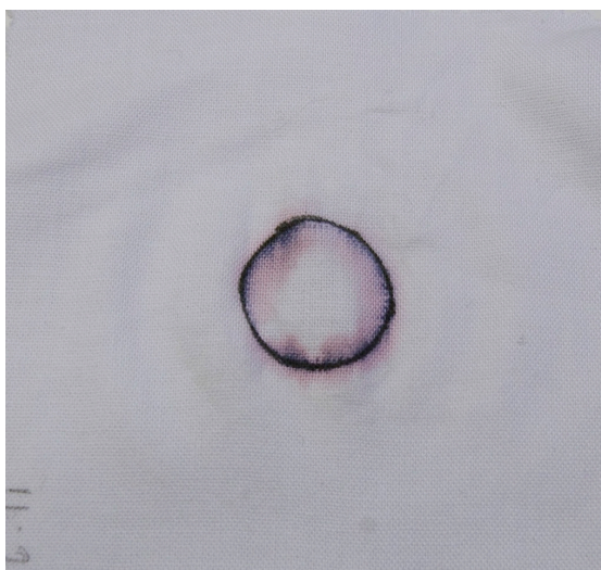
Figur 11. Isolerad blödning som skett under isoleringslagret bestående av cyklododekan och Paraloid B72.
