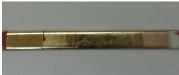
Fig. 9. Traditionella tekniker med; Polerat guld i animaliskt lim, provyta nr 1. Guld i linolja, provyta nr 3. Slagmetall i linolja, provytan nr 5. Bronsering, provyta nr 7.
