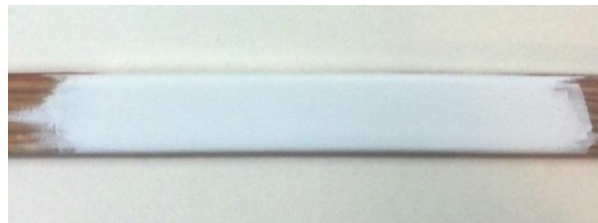
Fig. 8. Support av trä med kredering av animaliskt lim inför den traditionella förgyllningen.
