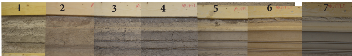
Figur 8 Påslagsomgångar Muffle-metoden. 1 grundning, 2-4 grovstockning, 5-6 finstockning, 7 finish
