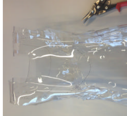
Fig. 17. Överflödigt material klippas bort. Foto: Hanna Johanson
