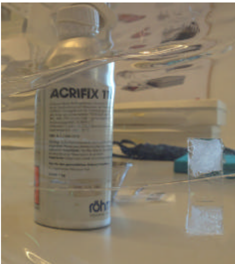
Fig. 18. Acrifix®116 används till att fästa skarvar på insidan av monteringen. Foto: Hanna Johanson
