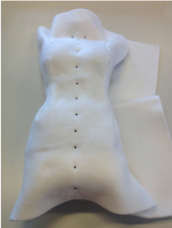
Fig. 10. För att sedan sys på maskin och fästas tillbaka ut och in på basformen. Foto: Hanna Johanson
