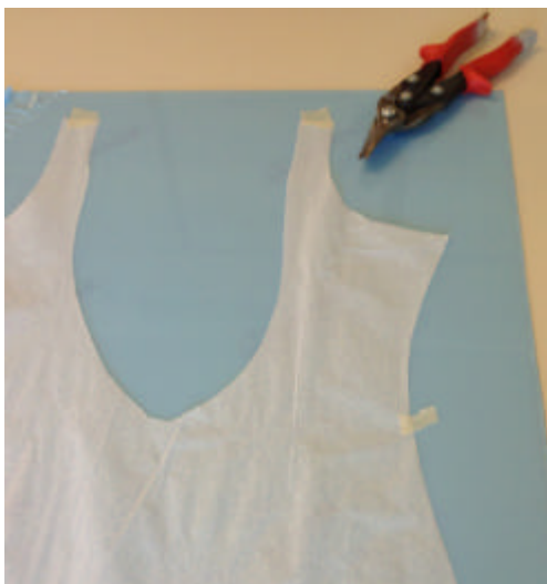
Fig. 15. Mönstret ritas upp på plastskivans skyddsfilm och klipps ut med plåtsax. Foto: Hanna Johanson
