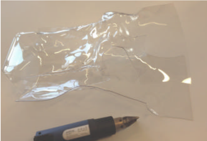
Fig. 16. En tredimensionell form arbetas fram med varmluftspistol. Foto: Hanna Johanson
