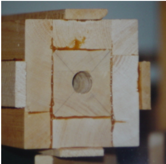
Fig. 6 Bildet viser hvordan valsen er limt sammen av tremoduler før den dreies og blir sylindrisk.
