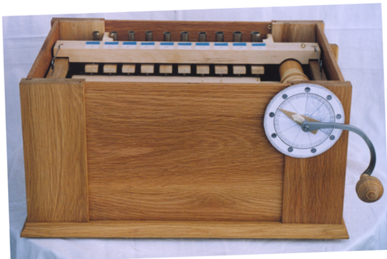
Fig. 10 Baksiden av serinetten med taktstikven festet og viser satt på sveivens akse, slik at den roterer samtidig med sveiven.
