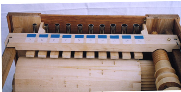
Fig. 13 Tangentene trykkes ned på valsen slik at de danner merker for hvor stiftene og broene skal sitte. Tape avmerkningen på klaverbjelken antyder skalaen.
