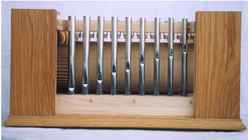
Fig.5 Serinetten sett forfra. Ni av de ti metallpipene er synlige. Den dypeste tonen, g,(pipen) er plassert til venstre. På pipestokken kan man se tre messingspiler som holder på plass den utskiftbare delen av pipestokken. Når messingspilene trekkes ut kan de fem pipene (giss, a, h, c, d) og i diskanten (g, a) løftes ut i pipestokken og erstattes med en annen pipestokkdel og piper slik at omfanget forandres.
