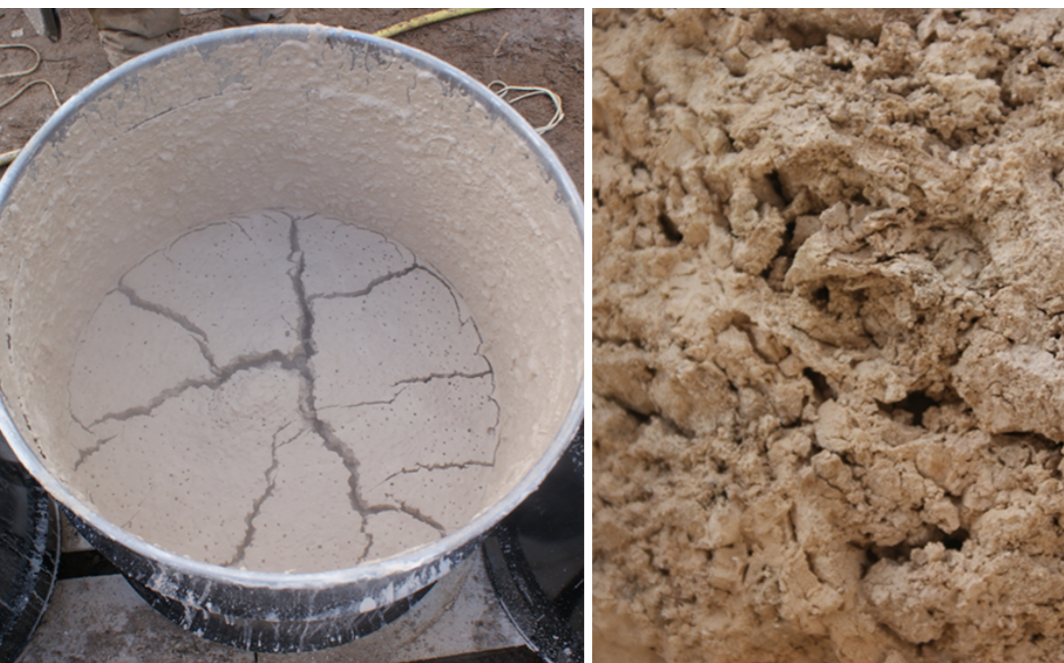
Fig. 68, 69. Andra släckningen utförs i samma kärl ovanpå ytan av den tidigare släckta kalken som efter ca 15 minuter är styv och fast (fig. 68). Vid andra släckningen hålls mer vatten i släckningskärl än vad som användes vid första släckningen beroende på att det rinner ner vatten i sprickorna som uppkommit i kalken samt att kalken under ytan innehåller grova porer (fig. 69).
