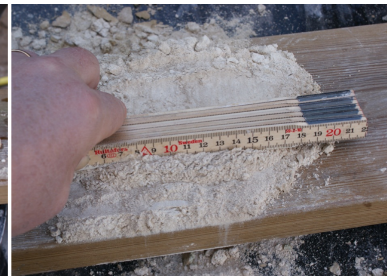
Fig. 56. När kalkstenen hålls en längre tid under vattnet och hela stenens tvärsnitt blivit genomfuktad sönderdelar sig kalken och efterlämnar inga kärnor av kalk. Genom att lätt trycka och röra i kalken undersöks om kalken innehåller några hårda osläckta delar. Resultatet skall bli ett pulver.
