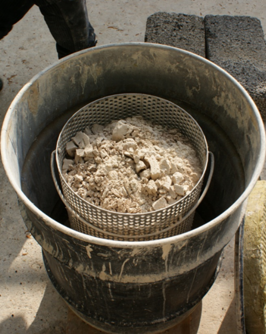
Fig. 46, 47. Under släckningen expanderar den brända kalken till ca den dubbla volymen. Direkt efter släckningen håller mindre stycken av den torrsläckta kalken samman (fig. 46). Kalken fortsätter att sönderdelas och utvidga sig en tid efter att själva släckningsförfarandet är avslutat. Det är därför en fördel om korgarna med den nysläckta kalken lämnas kvar i faten med isoleringsskivan kvar tills dagen efter (fig. 47).
