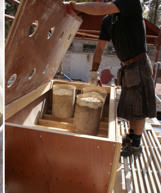
Fig. 48. Vid tömningen placeras åtta doppningskorgar (ca 220 l) med den släckta kalken i en behållare av plywood. Behållarens botten består av träribbor. Släckningskorgarna placeras på träribborna. På grund av att kalken dammar kraftigt är behållaren försedd med ett lock. I locket på behållaren finns åtta stycken hål. Doppningskorgarna är placerade direkt under dessa hål. I bild Tomas Sandberg.
