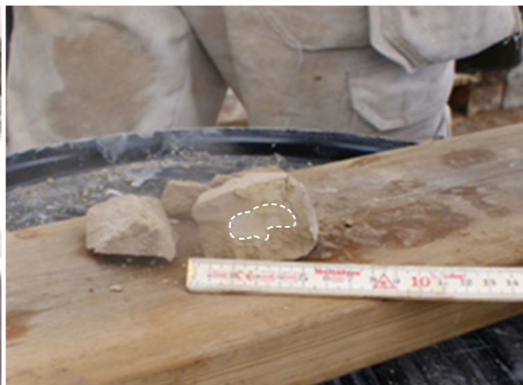
Fig. 54. Inom det vitstreckade området i stenens mitt syns ett område i stenens kärna som är ljusare. Tiden som kalken har hållits under vatten har i detta fall varit för kort då kalken inte är genomfuktad. Om den inte är genomfuktad tas en ny sten av samma storlek och doppas ytterligare ett antal sekunder. Därefter undersöks resultatet på samma sätt.
