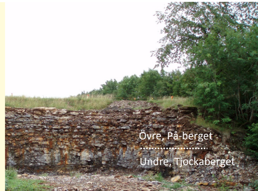
Fig. 20. Västergötland, Kinnekulle, Kakeled kalkbrott. Brytväggens höjd är ca sex meter. I brytväggen finns följande benämningar på bergets material; alunskiffer, orsten och linser. Brytväggen kan i höjd indelas i två sektioner, den övre och undre. Mängden kalk är som störst i den undre som benämns Tjockaberget eller stora Orstensbanken. Den övre benämns På-berget.
