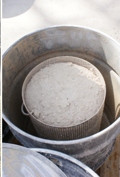
Fig. 46, 47. Under släckningen expanderar den brända kalken till ca den dubbla volymen. Direkt efter släckningen håller mindre stycken av den torrsläckta kalken samman (fig. 46). Kalken fortsätter att sönderdelas och utvidga sig en tid efter att själva släckningsförfarandet är avslutat. Det är därför en fördel om korgarna med den nysläckta kalken lämnas kvar i faten med isoleringsskivan kvar tills dagen efter (fig. 47).
