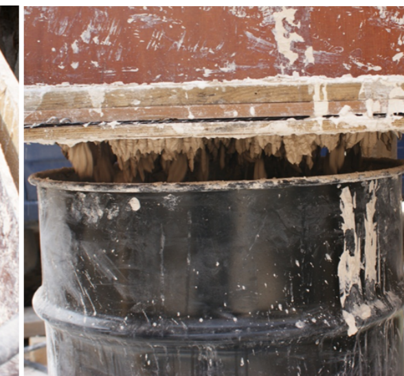
Fig. 77. Stående under sållet är det tomma fatet som släckningen utfördes i. Kalken är efter upparbetning tjockflytande med tixotropa egenskaper. I anslutning till sållets överkant är en vibbrostav placerad. Användningen av vibbrostaven är nödvändigt och gör kalken mer lättflytande. Detta för att kalken skall kunna passera sållet.
