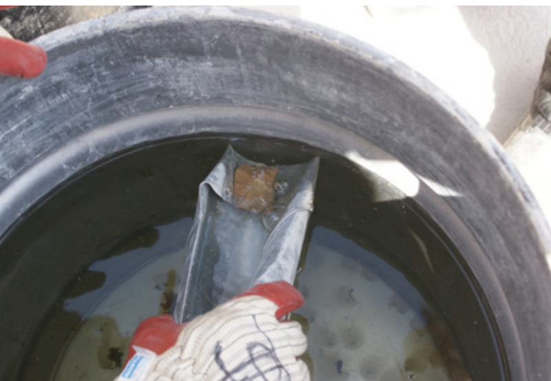
Fig. 53. Kalkstenen som skall våtsläckas doppas i ett antal sekunder i kallt vatten. Därefter delas kalkstenen med en kniv och hammare för att okulärt se om kalkstenen är genomfuktad. Tvärsnittet på kalkstens tunnaste sida bör ej överstiga 50 mm.
