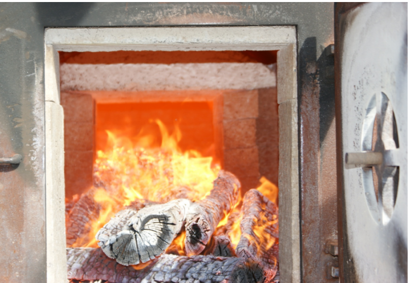
Fig. 32. I bildens bakgrund syns förträngningen som är placerad mellan förugnen och utrymmet under rostrett/kalkstenen. I förträngningen placeras den glöd som inte brunnit ut så att det täcker förträngningens halva höjd. Genom förminskningen ökar hastigheten på flödet av heta gaser i förträngningen. Den ökade hastigheten ger upphov till en blästereffekt som får glöden att förbrännas fortare.
