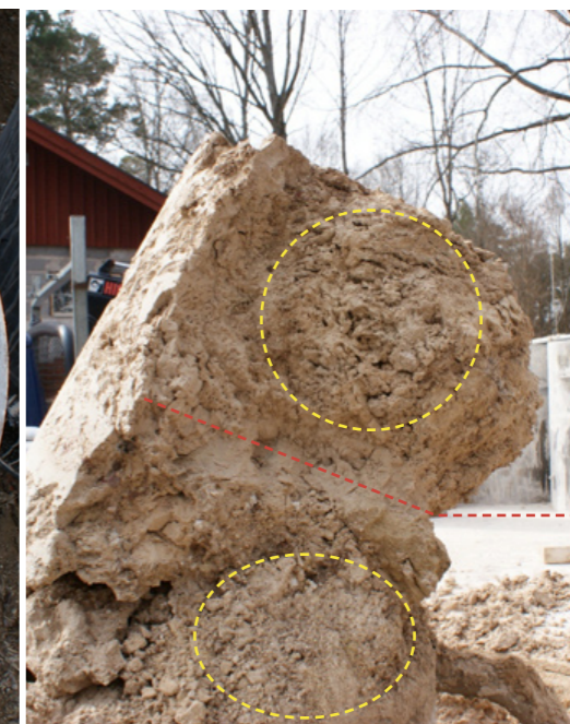
Fig. 72. Bilden visar den släckta kalken sedan den tömts ur släckningsfatet. Den rödstreckade linjen markerar gränsen mellan första och andra släckningen. Gul streckad linje markerar den inre kärnan av släckningen. Kärnan håller ihop, är fast och grovporig, kalken runt kärnan är fast och mer homogen. Kärnan i den andra släckningen är smulig och fuktig och håller inte ihop. Runt kärnan är kalken fast och mer homogen.
