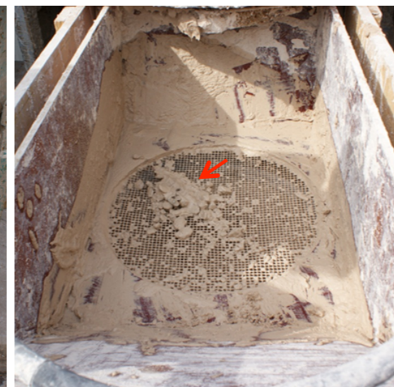
Fig. 76. I bild syns på sållet rester av andra bergarter, i huvudsak skiffer (den röda pilen). Kärnor av obränd kalk förekommer också.
