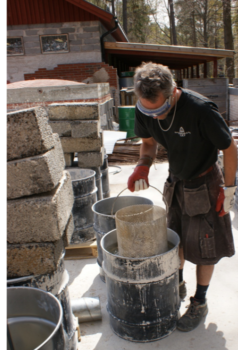
Fig. 43. Vattnet tillsätts kalken genom att en till hälften fylld perforerad korg med kalksten (ca 9-10 kg) doppas i kallt vatten under 25-30 sekunder. Därefter lyfts kalken upp och överskottsvattnet får rinna ur korgen innan den placeras i släckningsfatet. Korgens perforerade hål är ca 10 mm. Tidigare har korgar med 6 mm hål används men de är tyngre samt att hålen fort blir igentäppta av kalkslam. I bild Tomas Sandberg.
