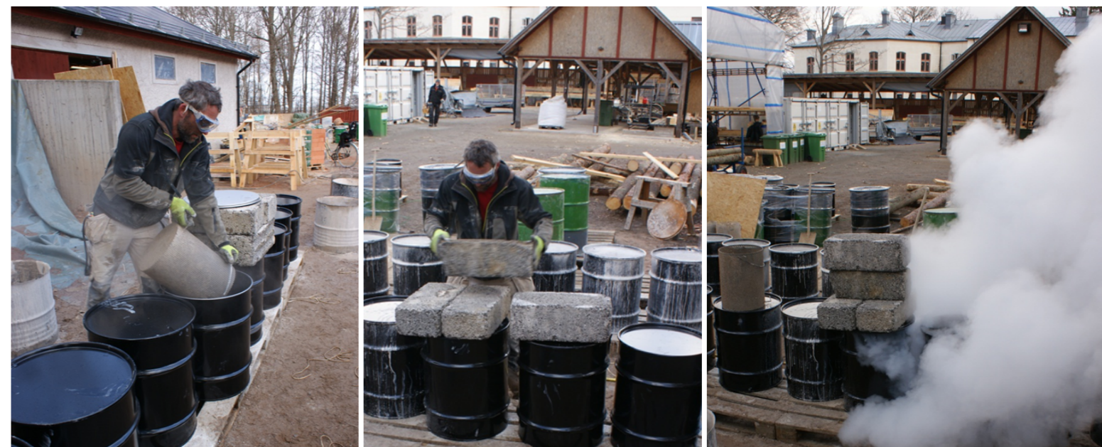
Fig. 65. Korgarna med bränd kalksten doppas i kallvattentunnan under ca 25-30 sekunder varefter korgarna lyfts upp. Under några sekunder får överskottsvattnet rinna av innan kalken hålls ner i släckningsfatet där det varma vattnet strax innan hålls i.
