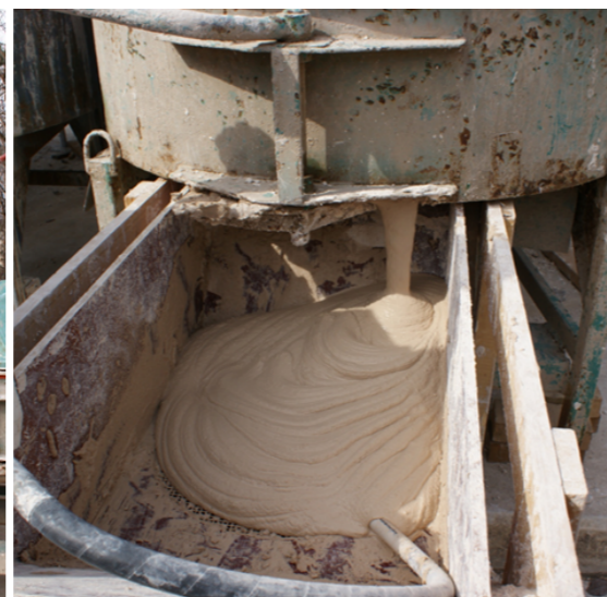
Fig. 75. Den upparbetade kalken tappas ur planblandaren ner i lådan. Lådan står på ben och kan flyttas mellan blandarna. I lådans botten är ett såll monterat. Sållet har en fri maskvidd på 6 mm. För att underlätta och öka hastigheten vid sållningen av den tjockflytande kalken är en vibbrostav placerad i lådans botten över sållet.
