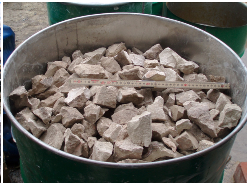
Fig. 58. I samband med att den brända kalkstenen lastas ur ugnen huggs den upp i ca 5 cm stora bitar. Därefter förpackas och lagras kalken i lockringsfat. Fatens lock är förseglade med vattenfast tejp. Kalken kan på detta vis lagras i minst ett års tid under förutsättning att ingen fukt eller luft kommer in i fatet.
