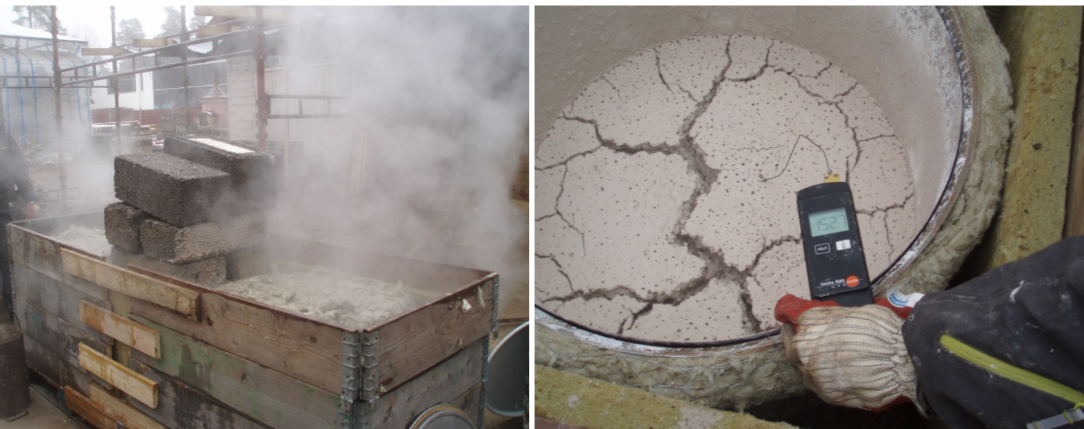
Fig. 79 och 80. Släckningen utfördes i en låda bestående av pallar och pallkragar. Lådans botten och sida var isolerade med 50 mm mineralull (markskiva). I lådan placerades släckningskärlet bestående av ett itukapat oljefat (ca 80 L). Fatet är isolerat med 30 mm mineralull. Vid släckningen fylldes fatet med ca 25 L 80°C vatten. Där efter doppades 28 L kalk (ca 19,5 kg) under 30 sekunder i kallt vatten innan den hälldes i släckningsfatet. Därefter sattes locket på fatet och täcktes med 50 mm mineralull. På isoleringen och locket placerades tyngder i form av lättklinkerblock (ca 60 kg). Efter att ångbildningen avtagit och det var säkert att öppna fatet mättes temperaturen i kalkpastan i fatet till 153-155°C (fig. 80).
