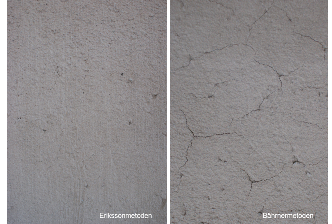
Fig. 83, 84. Bruket baserat på kalk släckt med Erikssonmetoden uppvisar inga torksprickor i putsens yta. På putsytan tillverkad med bruk baserat på kalk släckt med Bährner metoden (traditionella metoden) syns ett flertal kraftiga torksprickor i putsytan.
