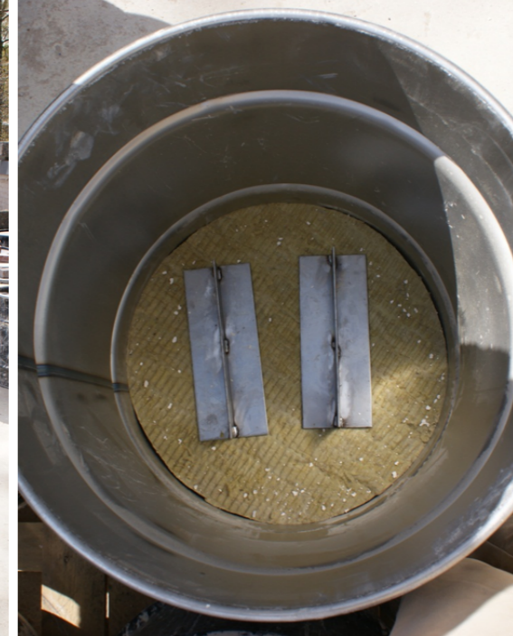
Fig. 44. I botten på fatet ligger en markskiva av mineralull. På markskivan är två vinkeljärn placerade. Vinkeljärnens uppgift är att korgen skall stå med ett fritt utrymme till botten, då ånga strömmar ur hålen i släckningskorgens botten. Samt att det kondenserade vatten som ansamlas i botten vid släckningen inte skall tas upp av den släckta kalken. Isoleringsskivan i botten av fatet var tänkt att minska avkylningen och kondensationen av ångan som alstras vid släckningen. Emellertid är funktionen tveksam varför den inte längre används.
