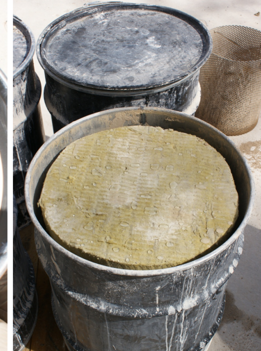
Fig. 45. Korgen placeras på vinkeljärnen med fritt utrymme till fatets sidor. Markskivan placeras uppe på släckningskorgen och motverkar att kalken blir blöt av det kondensvatten som bildas på lockets undersida vid släckningen.
