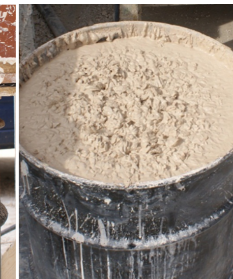
Fig. 78. Kalken är färdig att levereras. Fatet har använts i hela tillverkningsprocessen och återanvänds nu som förpackning vid leverans.
