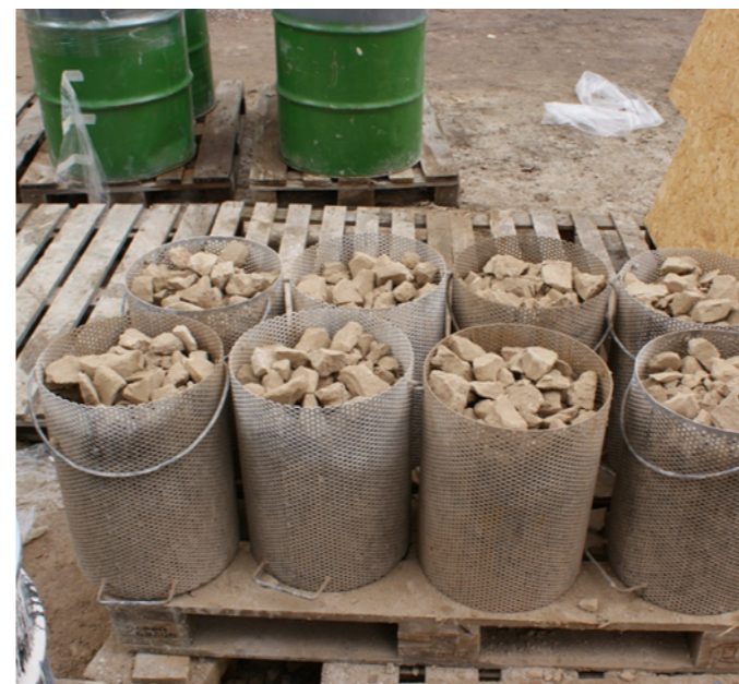
Fig. 59. Ett 220 liters fat räcker till att fylla 8 doppningskorgar. Fatet är emellertid tunga att hantera för hand varför 95-litersfat har använts under senare tid. Doppningskorgarna är tillverkade i perforerad plåt (10 mm hål) med måtten 300 mm i diameter och höjden 400 mm (28 L).
