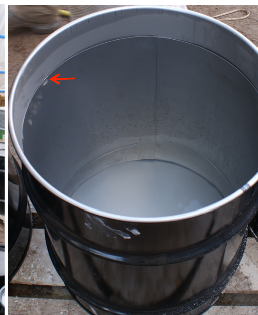
Fig. 60, 61. I det förberedande arbetet sätts plåtsvep i alla de uppställda faten (fig. 60). Svepen är öppna och valsade till en större radie än fatet. Effekten blir att svepet spänner mot fatets insida (se röd pil i figur 61). Om svepet inte spänner mot uppstår ett mellanrum mellan fatets insida och svepet. Under släckningen fylls mellanrummet med kalk och försvårar tömningen. Svepen är tillverkade i 0,7 mm svartplåt. Höjden är 500 mm och svepets plåtkanter överlappar varandra med ca 50 mm.
