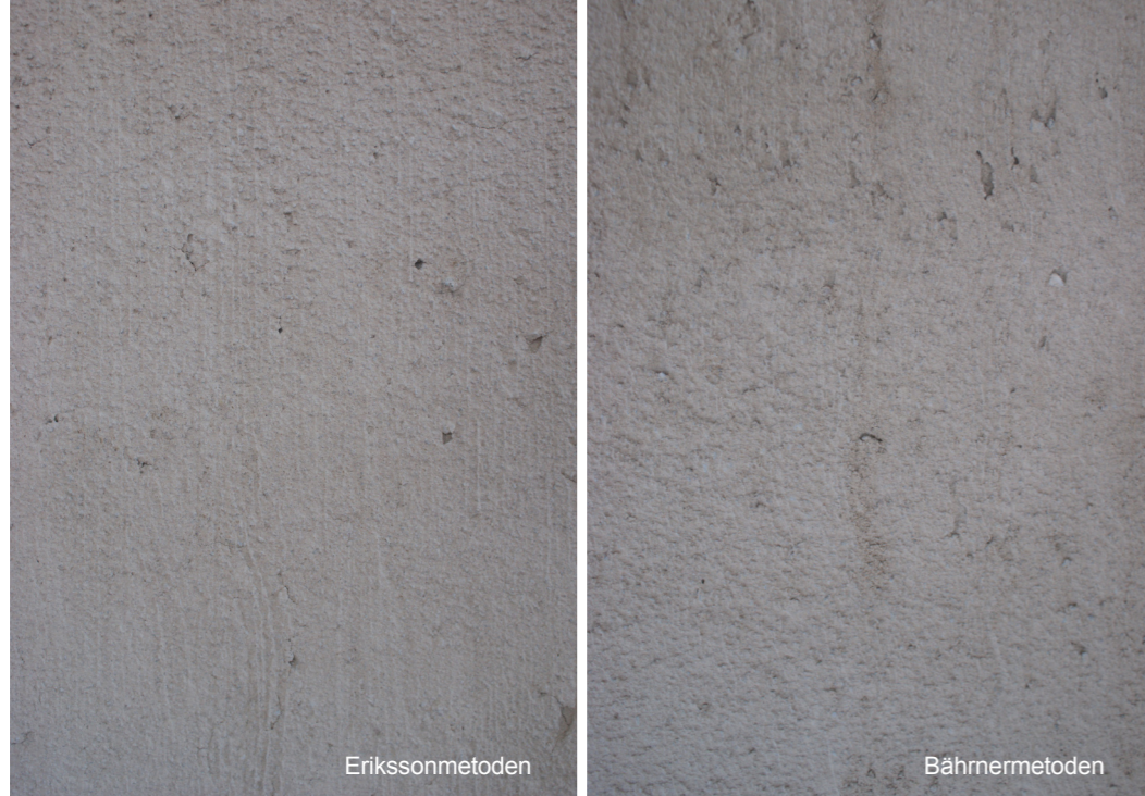
Fig. 81, 82. Vid ett blandningsförhållande på 5744 g kalkdeg på 14 800 g naturfuktig sand uppvisar ingen av putsytorna några krympsprickor.
