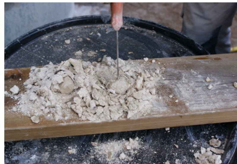
Fig. 55. Av bilden framgår att den yttre delen av stenen som blivit genomfuktad sönderdelar sig medan den inre kärnan av stenen som ej blivit genomfuktad lämnar en hård kärna av osläckt kalk.
