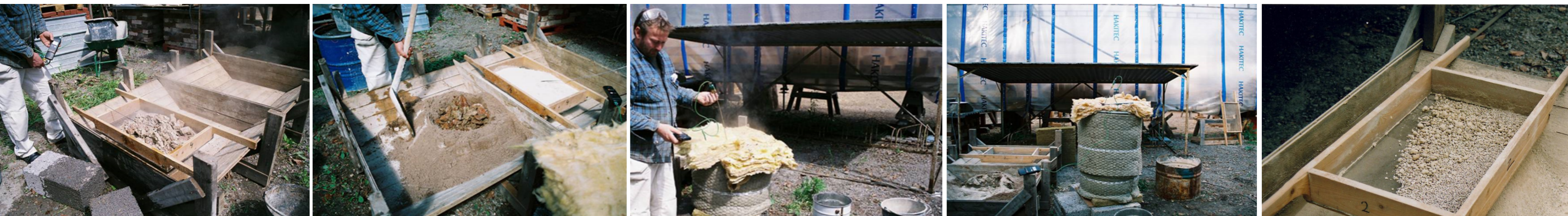
Fig. 51 a, b, c. Mariestad, Johannesbergsparken, Byggården. Fyra olika metoder användes. Genom släckningen på såll (fig. 51.a) placerades kalken fritt från underlaget. Värmen och ångan som bildades kunde fritt avgå. Vid släckning i stuka (fig. 51 b) placerades kalken i en grop formad av sand, kalken övertäcktes därefter med sand så kalken var helt omsluten. Vid släckning i isolerad tunna (fig. 51 c) var tunnan (ca 80 l) isolerad i botten, på sidorna samt övertäckt med löst liggande isolering. Vid släckningen passerar en del värme och ånga genom isoleringen.
