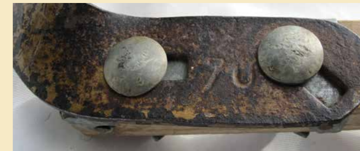
Ovan och under: Schweizisk lösning på fäste utan ring. Notera möjligheten att ändra cirkelvinkel genom springona i bladets tånge.
