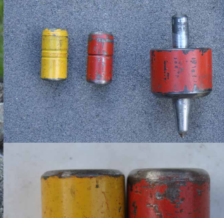
Peening jig med tillhörande hättor. Hättorna har olika avrundning där de träffar bladet.
