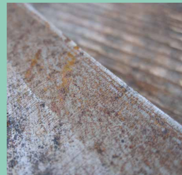
Slipblad med konkav undersida, alltså välvda i tvärsnitt, är lämpliga för denna slipmetod. Då kan man få eggen att peka mera neråt. På fotot ses undersidan av ett sådant blad där man endast slipat mycket lätt på yttersta delen av fasen.
