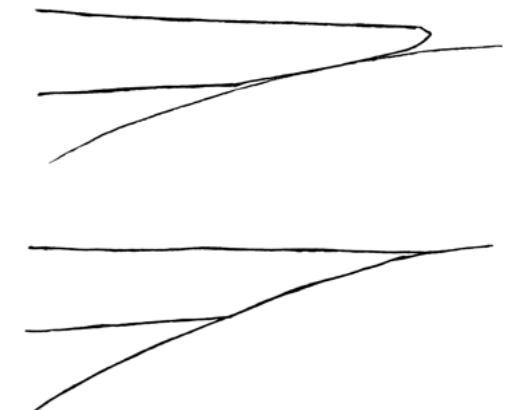
Egg i tvärsnitt på slipsten. Den trubbiga eggen (överst) blir slipad och fasen blir konkav. Eftersom slipstenen är rund åstadkommer den en liten eggvinkel utan att slipa av så mycket material.
