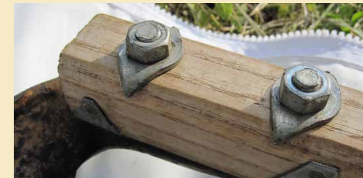
Ovan och under: Schweizisk lösning på fäste utan ring. Notera möjligheten att ändra cirkelvinkel genom springona i bladets tånge.
