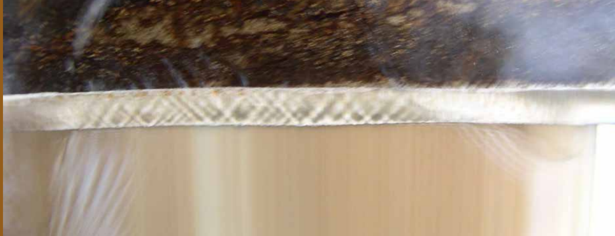
Slipblad på roterande slipsten. Notera V-formade brytningar i vattnet. Dessa visar på orenheter på andra sidan av bladet. När brytningarna försvinner är stycket färdigslipat.
