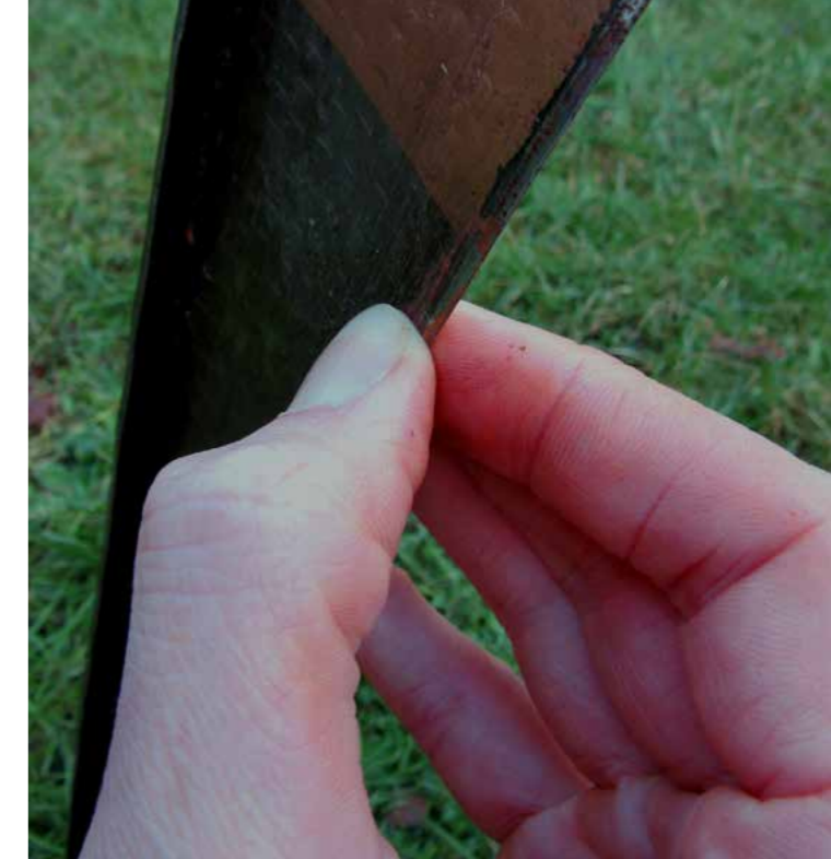
Klämma om fasen med spetsen av tumme och pekfinger. Med lite övning känner man skillnad på tjocklekar
