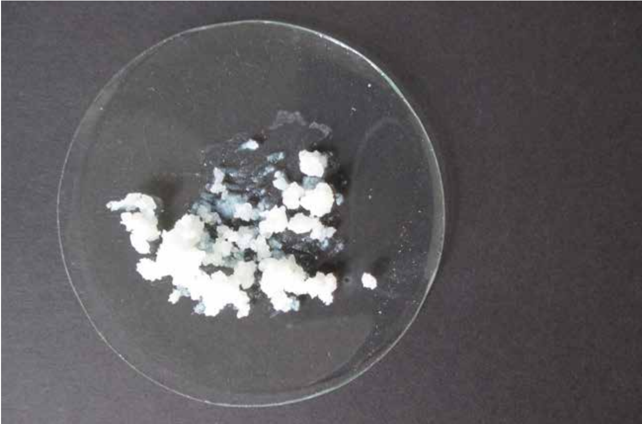
Några droppar utspädd saltsyra tillsatt i kalivattenglas reagerar omgående till en gel, en is-sörjliknande massa bildas som efter ett tag stelnar till en kristallglittrande torr och fast massa. Foto: Arja Källbom.
