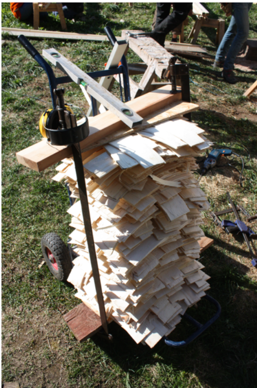
Figur 25. Resultatet en timmes spånhyvling. Foto: Gunnar Almevik
