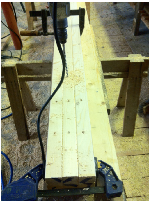
Figur 16. Olika sätt prövades att borra reglarna på först med en mall med hål. Jag kom fram till att det gick lättast för mig att använda en bräda där jag ritat upp centrumavståndet på hålen som jag sedan syftade utifrån. Hålen skulle inte behöva var så precisa så att en amatör inte skulle klara av att borra de. Jag experimenterade med olika borrarstorlek och tjocklek på bulten för att hitta en lämplig svårighetsgrad.
