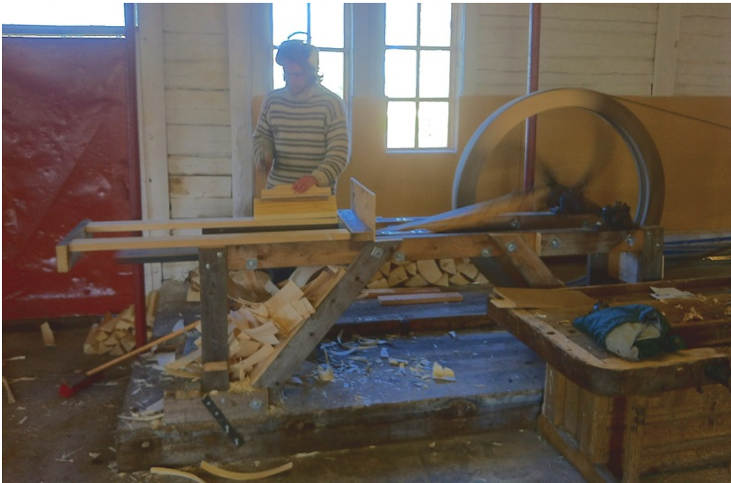
Figur 24. En av deltagarna monterar skyddsriggen vid spånhyveln. Av spånhyveln gjorde jag en säkerhetsgenomgång och visade hur jag använde maskinen till två deltagarna. Deras uppgift var därmed att föra deras nyvunna kunskap vidare. Så gjordes men tyvärr så var de kubbar som var kvar till de av något sämre art med för mycket kvist så resultatet blev därefter. Foto: Erik Nilsson
