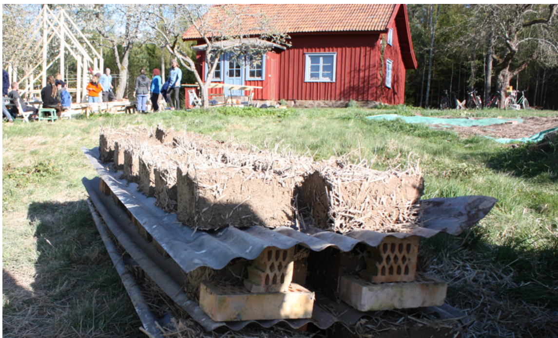
Figur 23. Några av de adobeblock som tillverkades under dagen. Foto: Gunnar Almevik
