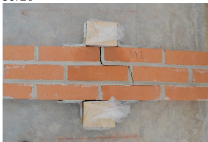
Weber färgat murbruk M1 C-klass Murtegel röd slät massivt 15/12
