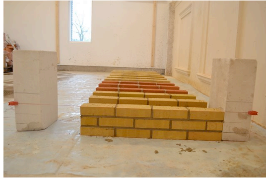
Murarna sett framifrån. Fogen ströks med en konkav fogslev på framsidan för att sprickorna ska kunna avläsas tydligare
