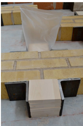
Passformen kontrollerades. Träskivorna omslöts av en plastpåse för att behålla fukten i träet.
