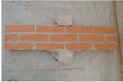
Exempel på provmur innan vattnet tillsatts.
