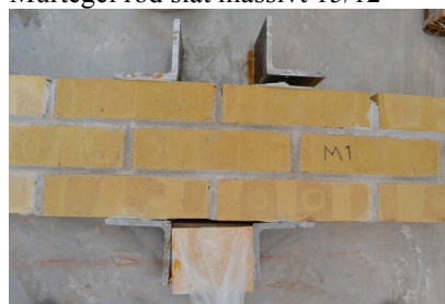
Weber färgat murbruk M1 C-klass Fasadtegel gult spånat massivt 35/28
