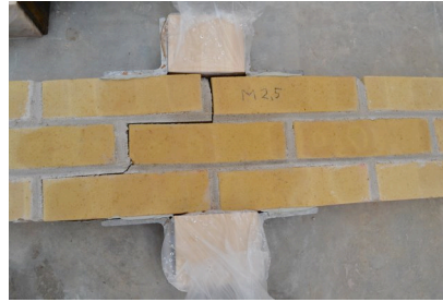
Weber färgat murbruk M2,5 B-klass Fasadtegel gult spånat massivt 35/28
