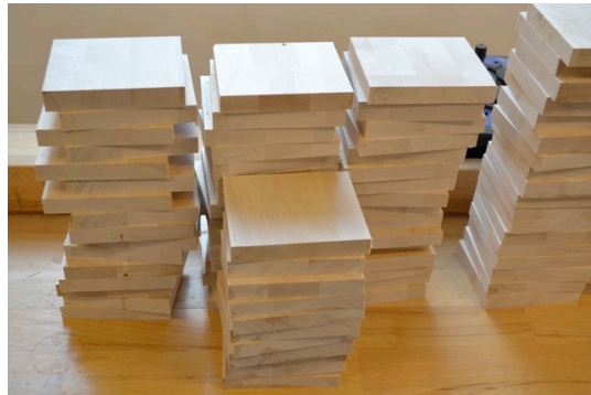
Björkskivorna sågades upp i dimensioner som varierade mellan 120-123mm bredd eftersom avståndet mellan L-järnen varierade något.
