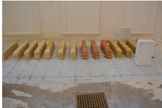
Murarna sedda från sidan. 3 provmurar tillverkades för varje sorts bruk samt en extra provmur att testa på.
