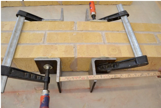
Avståndet kontrollmättes till 122-124mm. Limmet fick härda 8 dygn.
