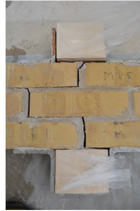
Weber färgat murbruk M2,5 B-klass Fasadtegel gult spånat massivt 35/28
