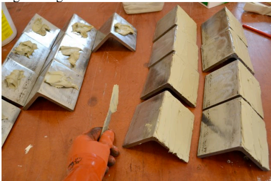
L-järnen torkades av med acetone innan epoxin ströks på.
