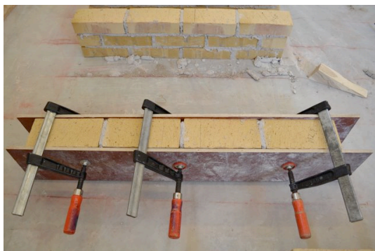
För att limma på L-järnen vältes muren efter ca 3 veckors härdningstid. Det gjordes genom att fixera formplywood längs mursidan och sedan försiktigt välta den mot två kilar.
