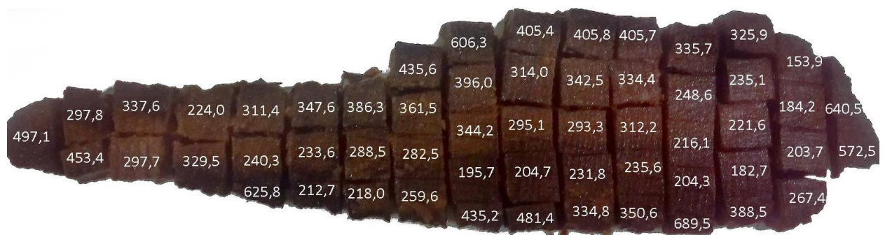
Figur 1 Tvärsnitt av provmaterial från Skaftövraket med värdena för Umax utskrivna
