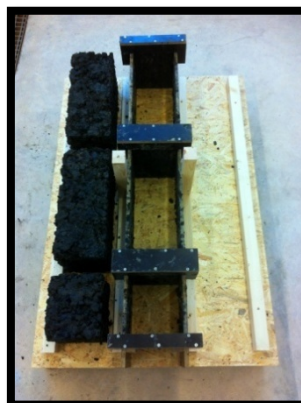
Figur 11. Blocken slås och formen flyttas.
