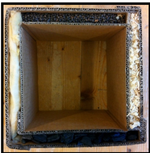
Figur 23. (Sett från vänster och sedan moturs) Mineralull, träkol, kutterspån och lättklinkerkulor.
