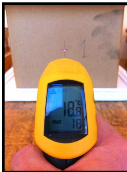
Figur 26. Mätning av ytemperatur. Notera laserpricken på lådans centrumkryss där temperaturen mäts.
