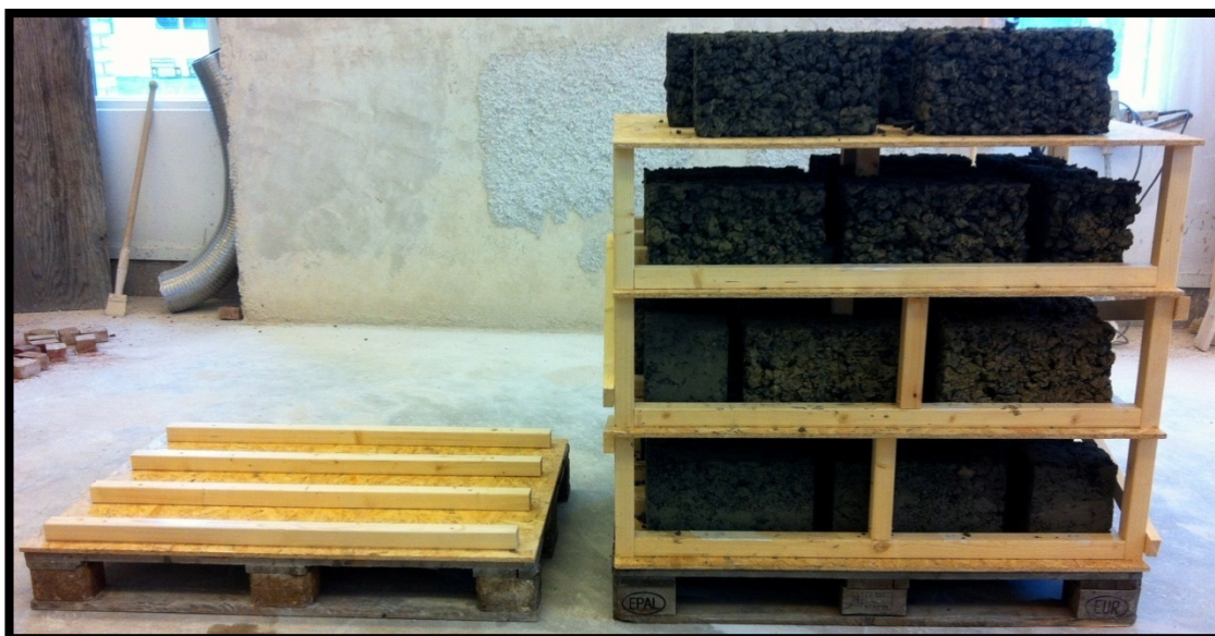
Figur 14. Blocken flyttas och omplaceras, från den högra torkställningen till den vänstra tomma pallan.
