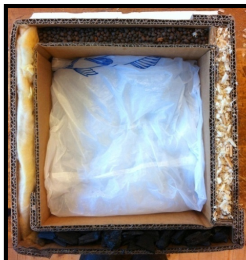
Figur 24. Plastpåse med is inuti lådan.
