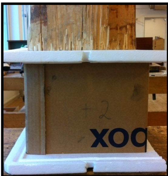
Figur 25. Cellplastskena som botten och lock samt vikt för att försluta lådan.
