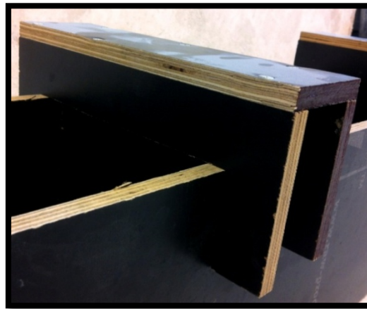
Figur 7. Bilderna visar bygel som låser formens långsidor och kortsidor i ovankant.
