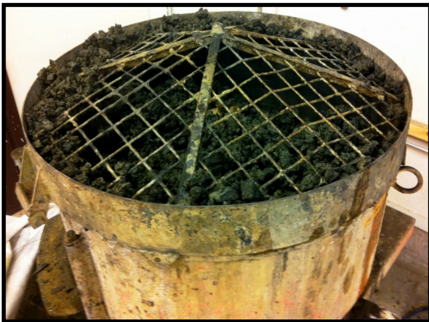
Figur 3. Planblandaren är fylld och blandningen tumlas runt på ett fördelaktigt sätt.
