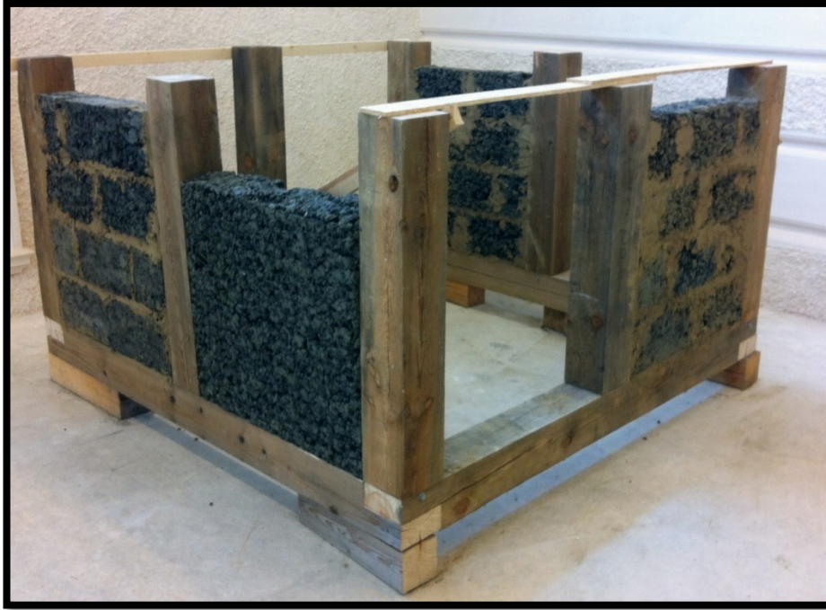
Figur 21. Tre fack är uppmurade och ett är direktfyllt.
