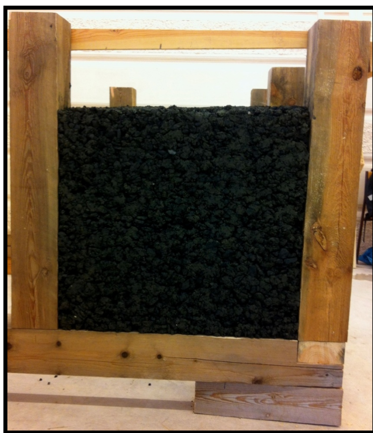
Figur 18. Materialet (92 liter) i stommen efter direktfyllningen.
