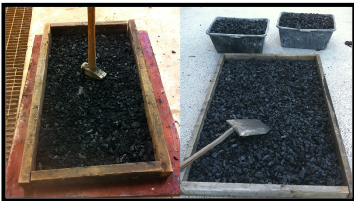
Figur 2. Sönderdelning av träkolen till mindre fraktion.
