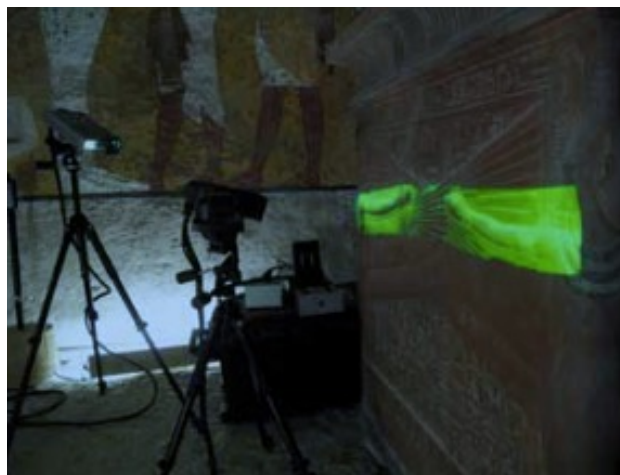
Fig. 1. Scanning med strukturerat ljus. photo©Factum_Arte.
