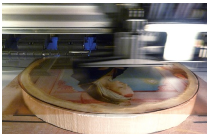
Fig. 4. Färginformation skrivs ut med flatbed-skrivare. photo©Factum_Arte.
