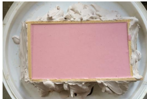
Fig. 6. Ramen har isolerats genom att gips har byggts upp runtom dess utsida och silikon har hållts innanför ramen, över lermodellen.
