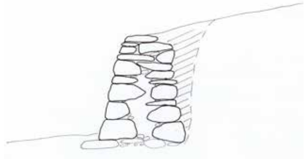
Stödmur med två murade sidor och kärna av t.ex. stenpackning. Ena sidan döljs av jorden.
