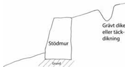
Dränering med dike ovanför stödmuren.
