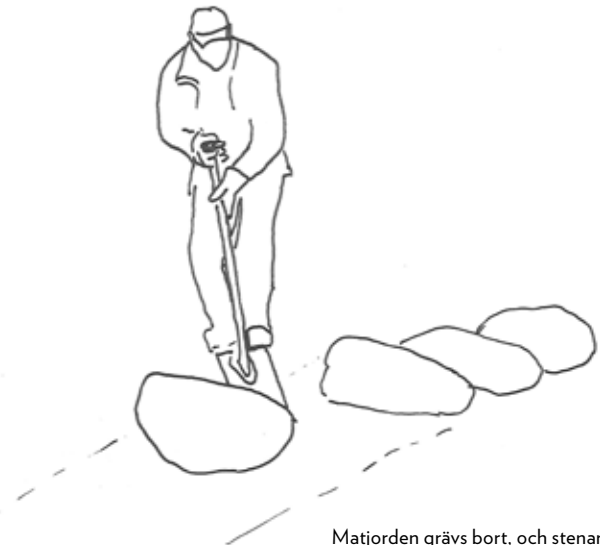
Matjorden grävs bort, och stenar som inte ligger stabilt kan grävas ner lite.
