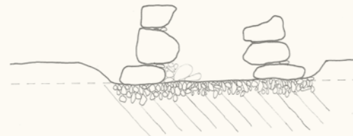
Matjorden borttagen och jorden kompakterad. I det här exemplet används också murfot under marknivå för att förbättra grunden.
