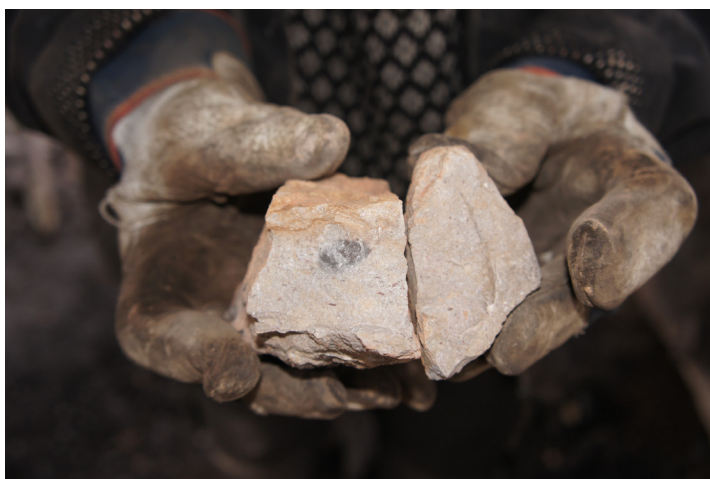
Figur 42. I stenhalvan till vänster syns en tydlig grå kärna. Detta visar att stenen är ogenombränd. Stenhalvan till höger genombränd.
