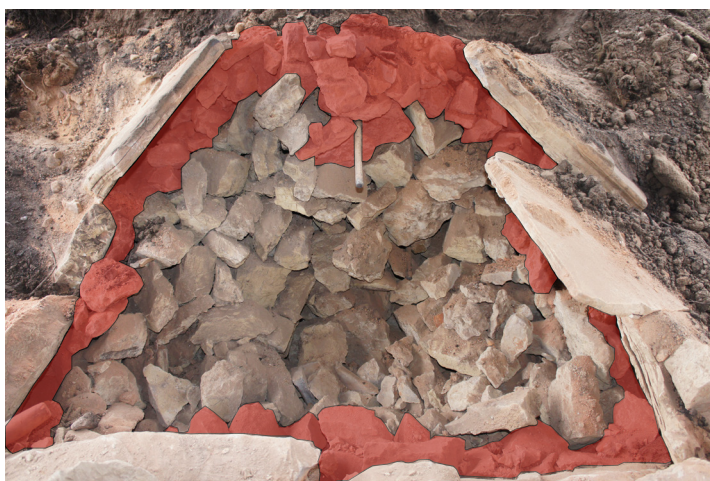
Figur 43. Den röda markeringen visar de områden där det var mest ogenombränd sten. Anmärkningsvärt är området runt den övre sonden, där stenar som befann sig längre ner och centrerat i ugnen inte blev genombrända.
