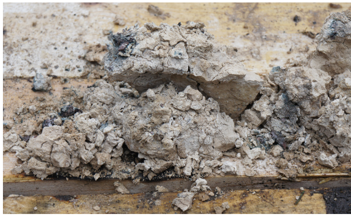
Figur 39. Provsläkning av kalkstenen. Släckningsprocessen har i detta skede precis satt igång.
