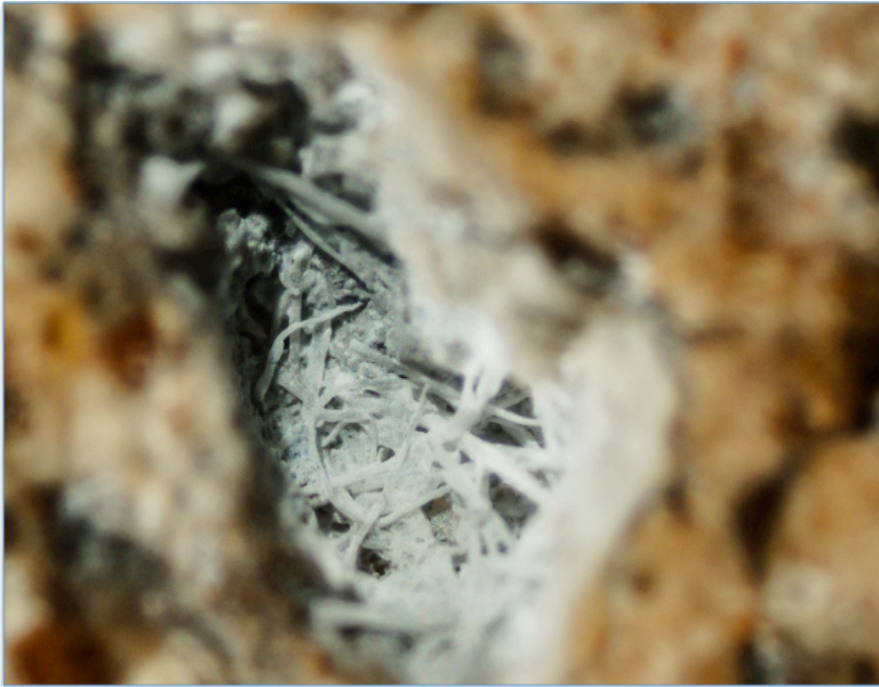
Fig 26. Optiskmikroskop bild. Förstoring 10x. Visar en hålighet i putsen där det finns fiber.
