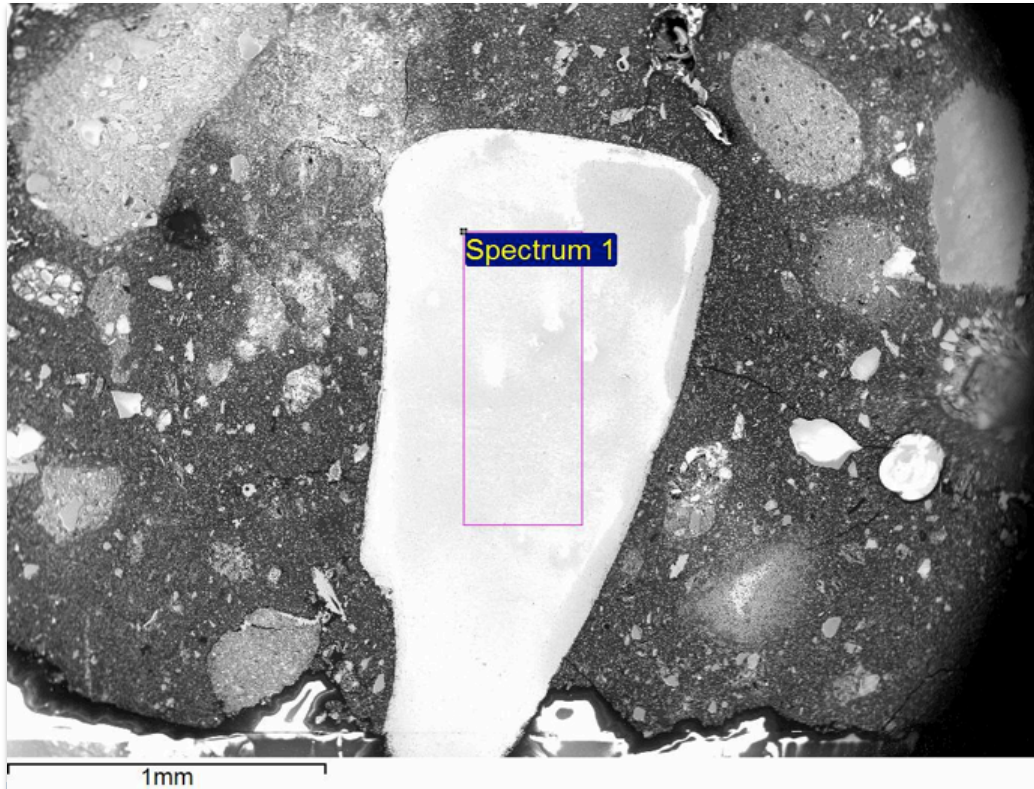
Fig 17. SEM bild. Visar ett aggregat som inte är tegel.
