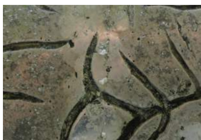
Fig. 13. Detaljbild av verk 15, som visar vita korrosionsprodukter på ytan.
