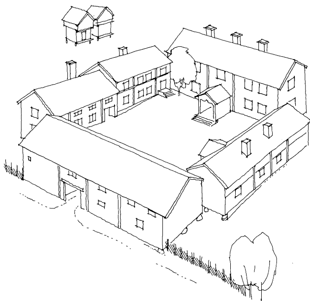
Kringbyggt gårdstun, läskyddat och solvärm.
