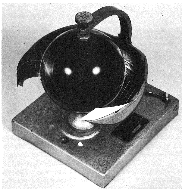
FIG. 2. Solskenstiden registreras med heliograf, som fungerar som ett brännglas och markerar solskenstiden på en pappersremsa under förutsättning att strålningsintensiteten uppgår till ca 230 w / m 2 (200 kcal / h, m 2 ). Denna intensitet uppnås vid en solhöjd av ca 3° under klara dagar.
