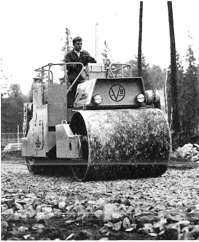
10-tons vibrerande tandemvält med vibrering och framdrift på båda valsarna.
