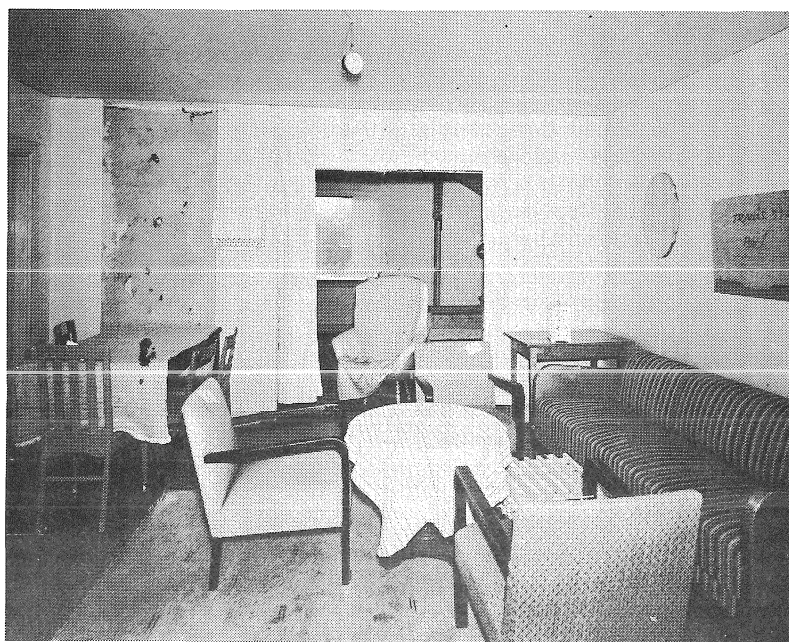
Prov I i övervåningen, rum B från norr. I bakgrunden rum A. Tändanordningen (brandhärden) till höger på bilden mellan soffan och runda bordet.
