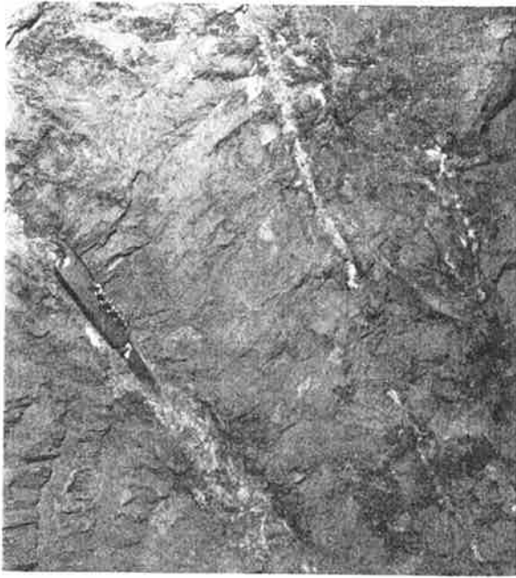
Fig. 16. Vertikal skifferyta med mineralgångar. Skiffern är intill dessa av mjöliknande konsistens
