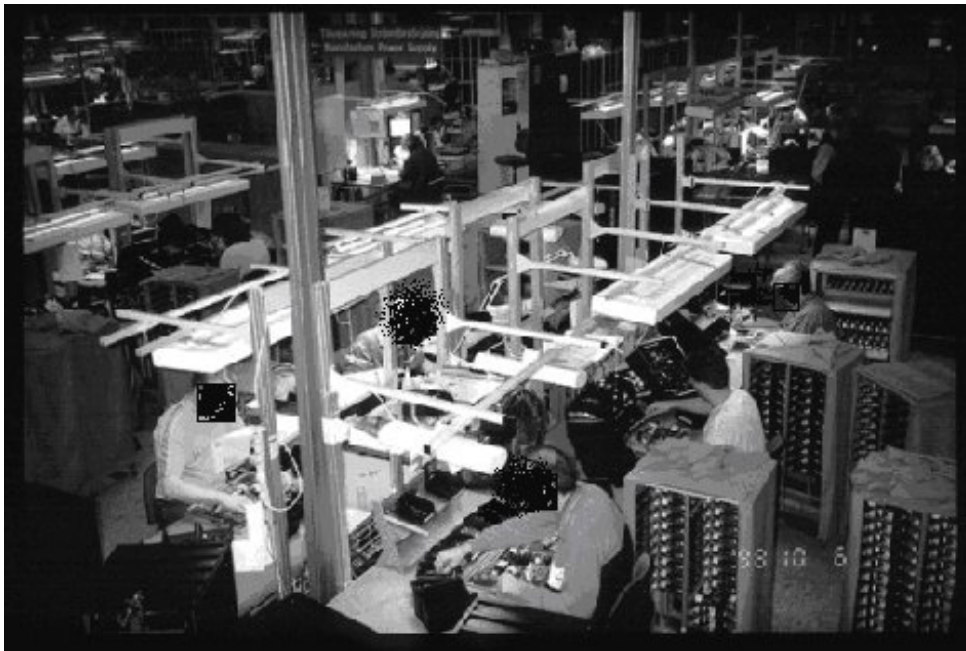
Figur 2. Manuell montering i det gamla systemet med mellanlagring i vagnar hos varje montör.
