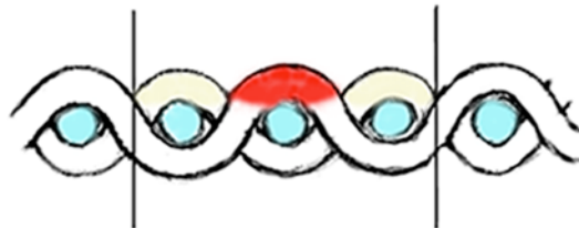
Bild 9: Snitt av provkropp i genomskärning. Ytan som analyseras med ESEM-mikroskopet är markerad med röd färg. Blå färg markerar varptrådarna.
