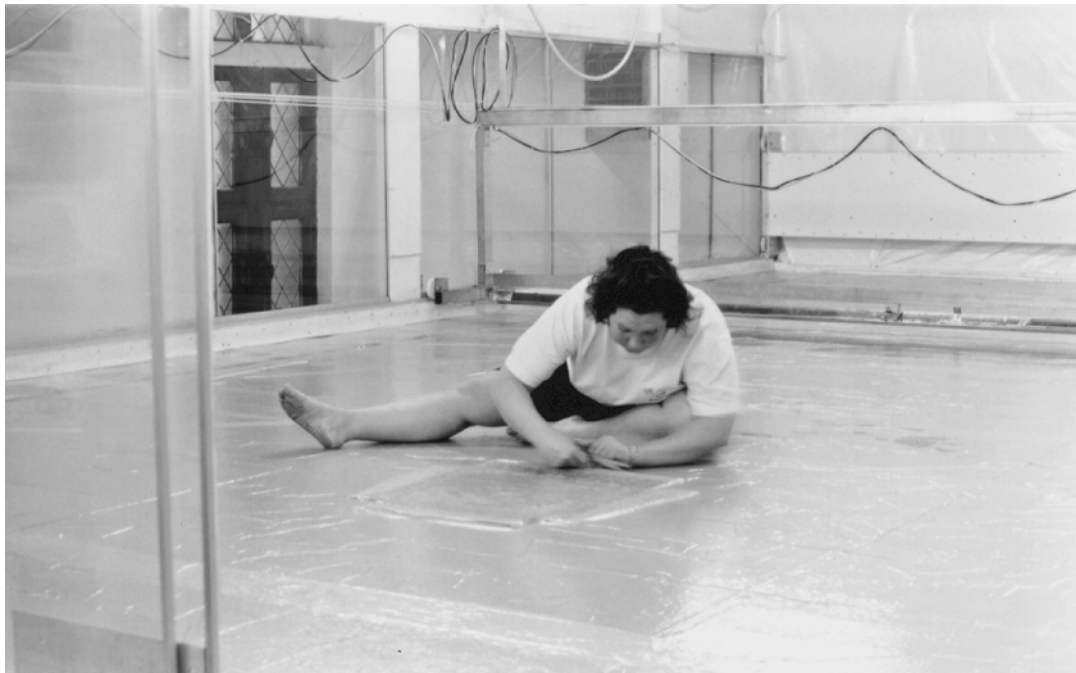
Bild 19: Outnyttjad yta på lågtrycksbordet maskas av med plastfilm runt tapeten. Lägg märke till den lilla tapeten, "Get&får", på det ca 45 m 2 stora vaccumbordet.
