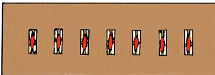
Bild 10: Provkroppar monterade i skåror på en kartongbit, sett uppifrån.
