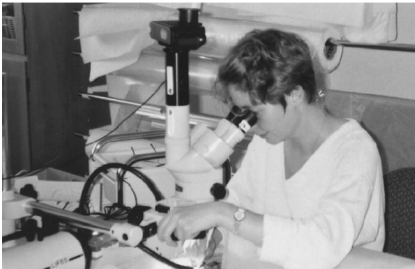
Bild 5: Analys och fotografering med stereomikroskop. Kameran är monterad högst upp på mikroskopet.
