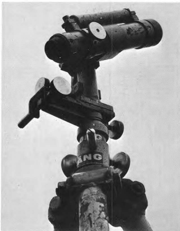
Fig. 9. Lodinstrument, fabrikat Berg. Rörvattenpassets känslighet 35". Förstoring 16 ggr.
