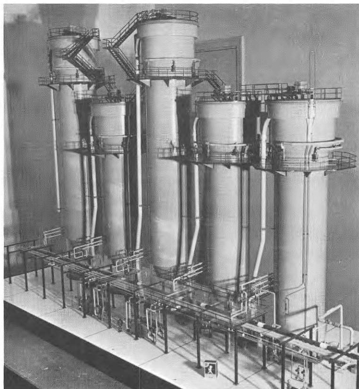
Bild 2.3.3 Blekeri för massafabrik, modellskala 1:20
