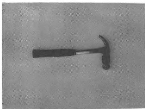
FIG. 25. Hammare använd vid testning av förmåga till maximal energiutveckling i hammarslag.
