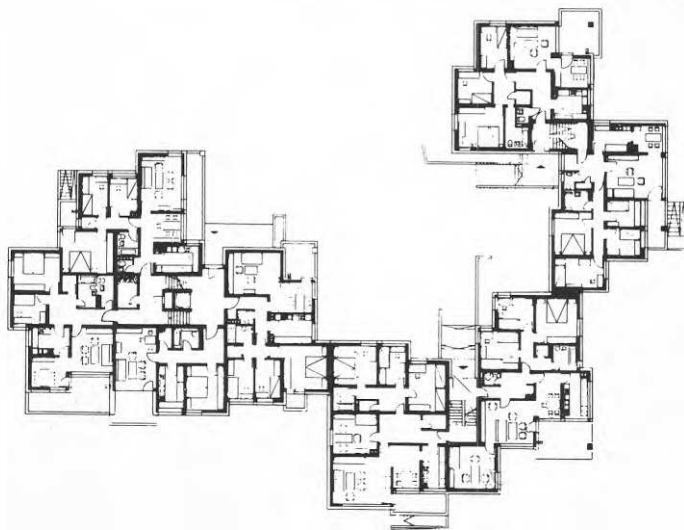
EXEMPEL HUS B4-B5 PUNKTHUS VERTIKAL FÖRSKJUTNING I TRAPPHUS KOPPLAT TILL LAMELLHUS. ASPEI TYSKLAND. ARK. R REISER M.FL.
