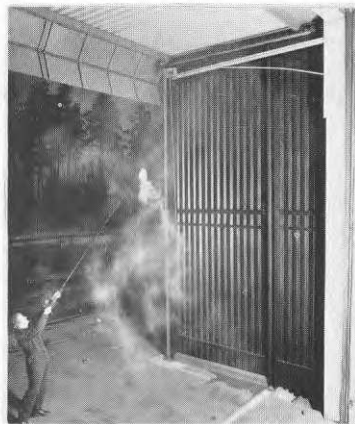
Figur 3.7 Port vid Bahco Industri med rökvisualisering av luft-ridååterstyrningen
