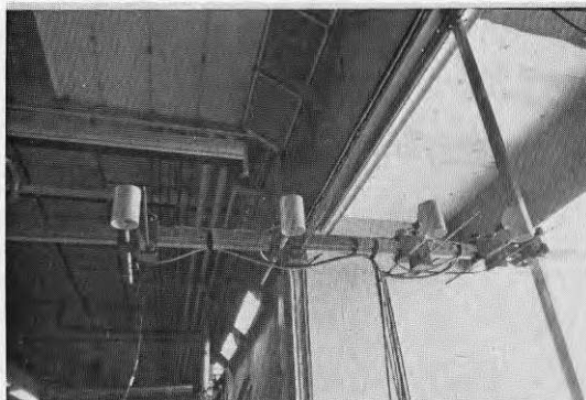
Figur 3.8 Mätstånd med termistor-termometer placerade i ett skyddande rör samt de riktningsoberoende hastighetsmätsonderna fabrikat TSI 1610
