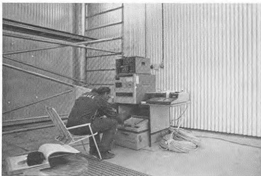
Figur 3.9 Datalogger med signalomvandlingsenheter, dator och ansluten plotter för kontroll av aktuell hastighetsfördelning i ridån
