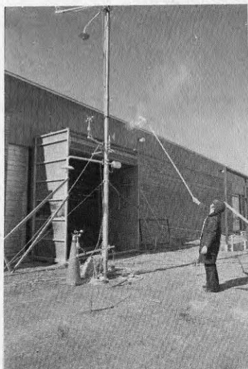
Figur 3.10 visar mätsonderna för vindhastighet på 1.05 och 3.25 samt temperaturmätsond på 2.35 m över mark. Vindriktningsflöjel på 3.25 m över mark syns snett bakom masten
