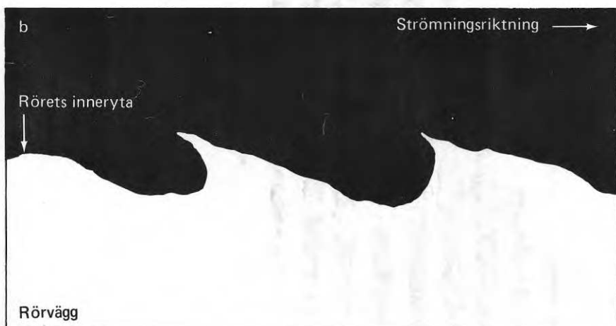
FIG. 1. Tvärsnitt genom erosionskorrosionsangrepp i prov av dimensionen 6/4 mm exponerat för luftmättat vatten med strömningshastigheten 12 m/s, 65°C och kontinuerlig strömning a) pH 8, b) pH 6,5. Förstoring 100 gånger.
