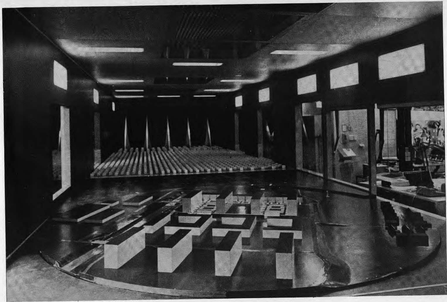
Fig. V.3 Modell av Kroksbäckområdet i vindtunneln. Modellskala 1:200.
