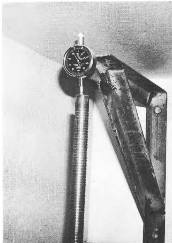
Fig. 13. Mätklocka fastsatt på en i bärande vägg fastbultad konsol.
