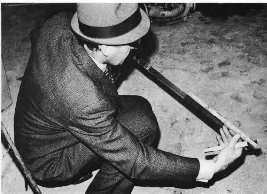
Fig. 10. Mätning av grundvattenstånd. Den våta delen av metallstängen mätes med tumstock.
