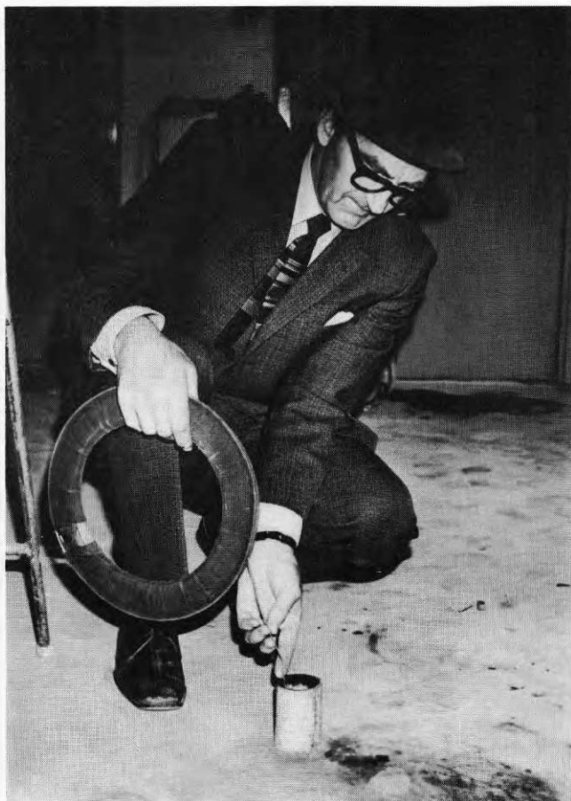
Fig. 9. Mätning av grundvattenstånd. Total längd till rörets överkant avläses.
