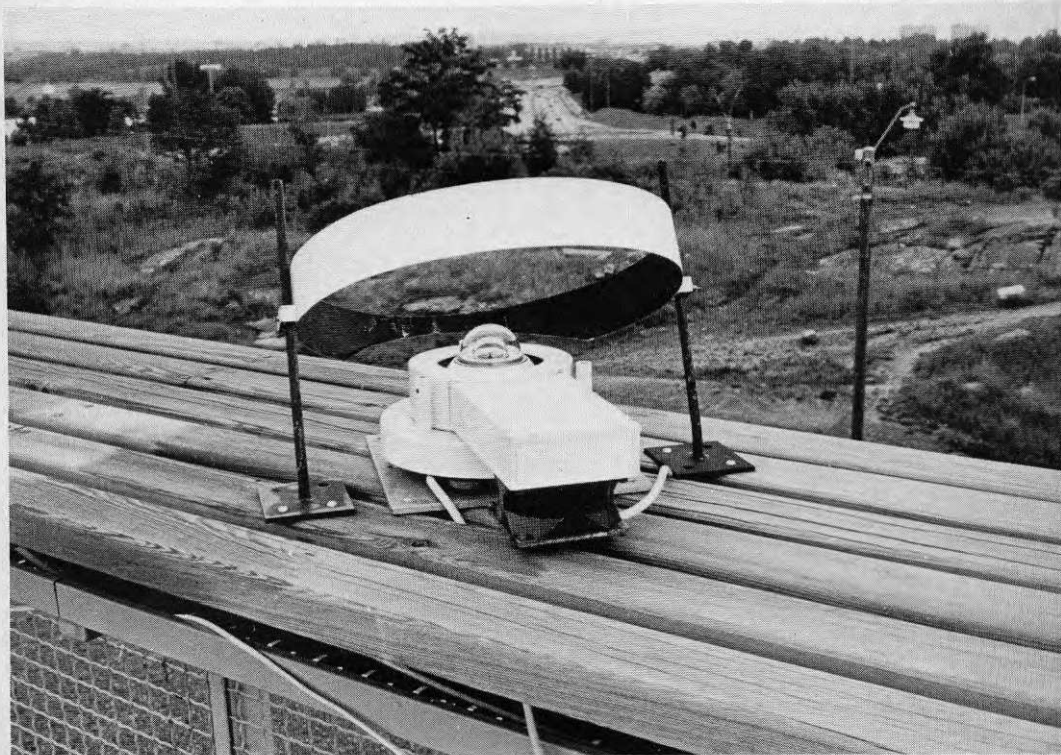
Pyranometer och skärm av den typ som använts i Stockholm Denna pyranometer är försedd med fläkt för att eliminera frost m.m..
