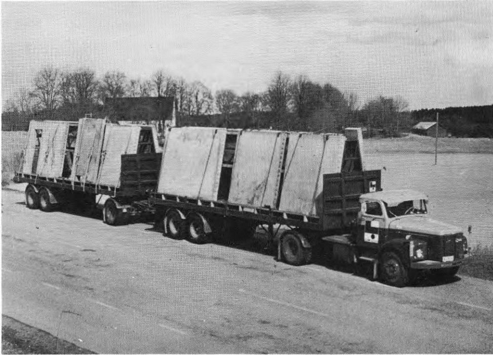
FIG. 7 Sverige. Fordon med standardpåhängsvagnar. Påsatta stödbockar för transport av innerväggs- eller fasadelement, utan stödbockar för transport av bjälklags-element. Ekipaget är dispensbeviljat från VTF p g a större fordonslängd än maximalt tillåtna 24 meter. (Foto: A Z Sellbergs AB)
