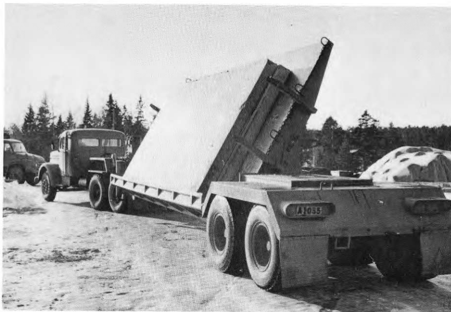
FIG. 3 Sverige. Fordon med hydrauliskt vippbar lastyta för transport av breda eller höga element. (Foto: Jonsson 1969)
