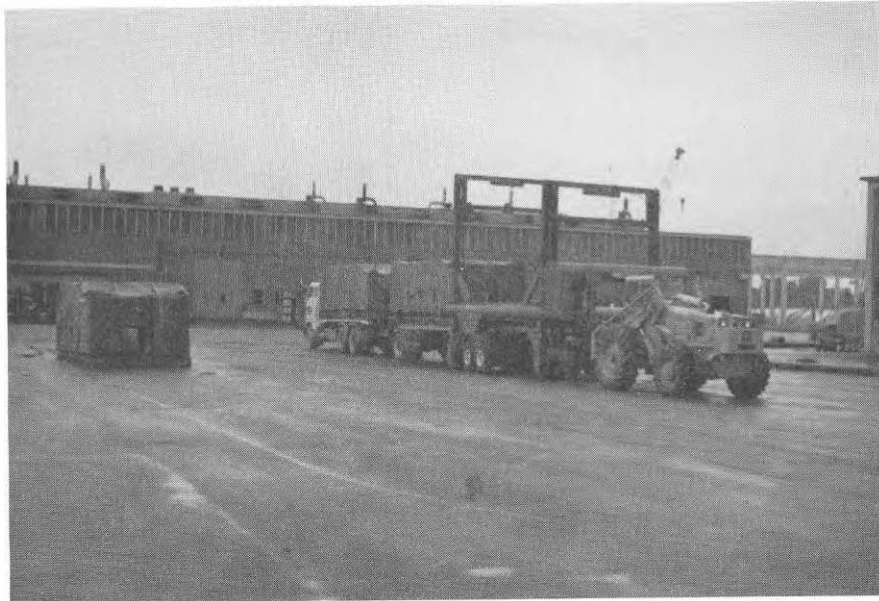
FIG. 74 Enkel och billig bygelvagn för snabb lossning av volymelement (Foto: AB Volvo).
