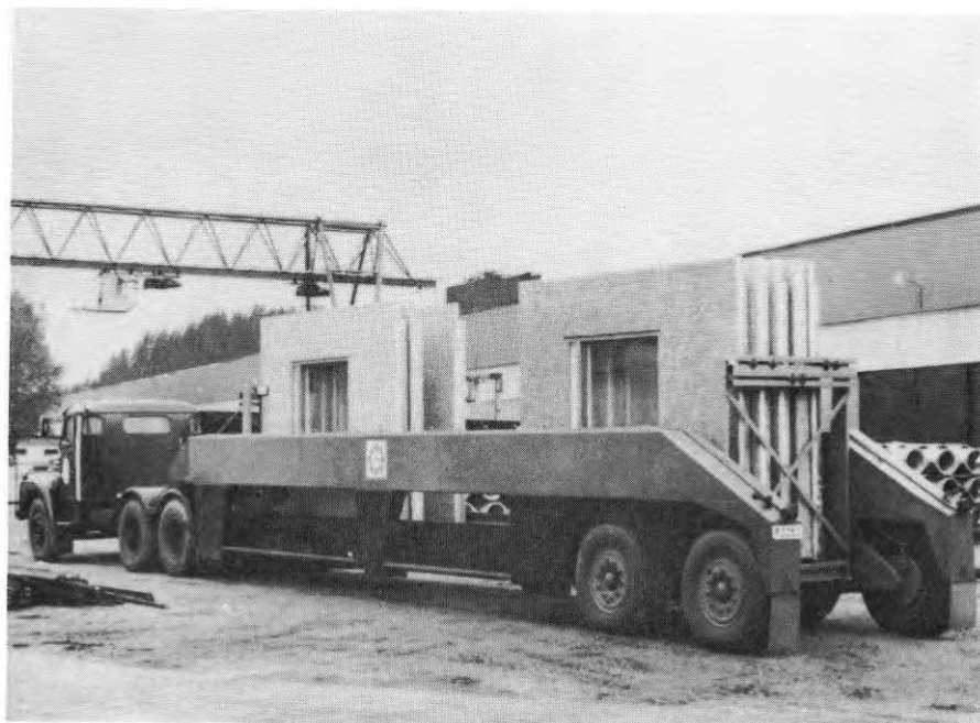
FIG. 4 Sverige. Fordon med bygelvagn och utbytbara lastbärare för transport av innerväggs- eller fasadelement. (Foto: Jonsson 1969)
