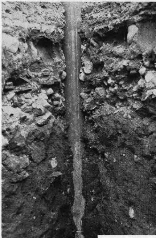
9. Foderrör P2, övre del i närbild.
