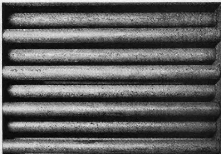
Figur 11. Värmeväxlare i syrafast stål SIS 2343. Ingen korrosion.
