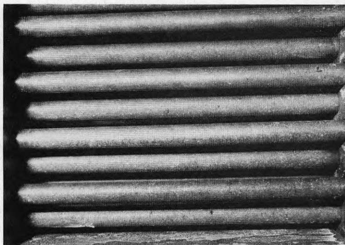
Figur 16. Värmväxlare i syrafast stål SIS 2343. Rörrens frontytter är belagda med stoft. Ingen korrosion.
