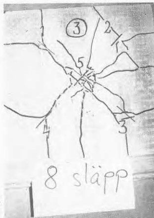
Figur 7.25. Baksidorna på provplattorna 3 och 4 efter 8 slag. Slagserie enl. tabellerna 7.25 och 7.26.
