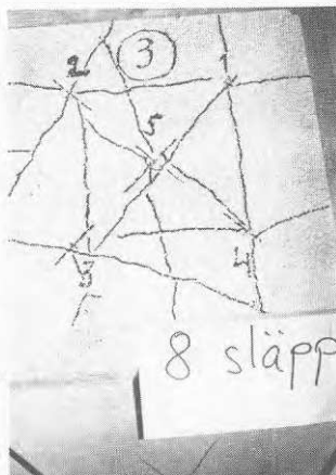
Figur 7.24. Ovansidorna på provplattorna 3 och 4 efter 8 slag. Slagserie enl. tabellerna 7.25 och 7.26. Inga sprickor på fiberarmerade plattan.
