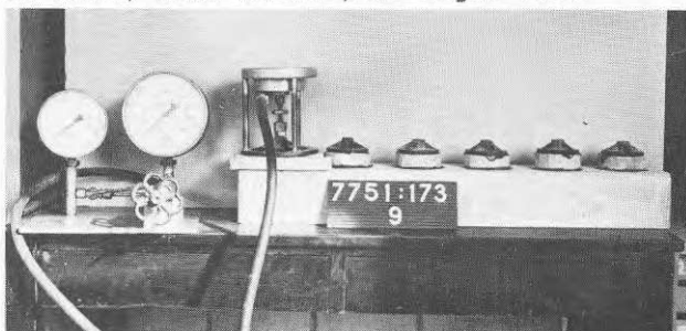
Figur 7.3. Provningsanordning för bestämning av tvärdraghållfastheten.
