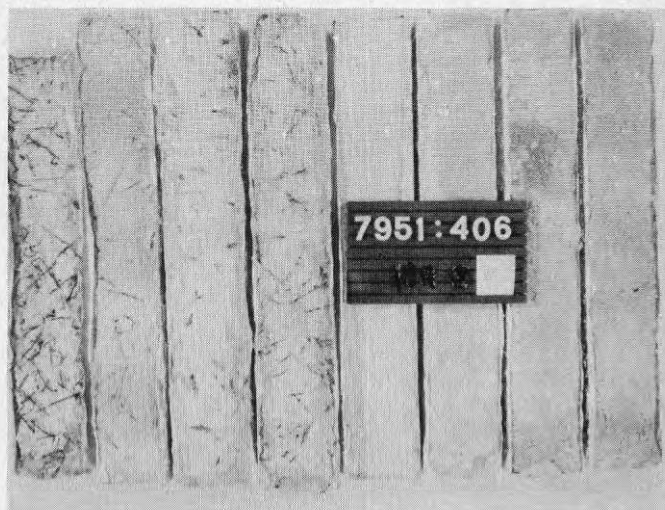
Figur 7.28. KC och KC+B efter korrosionsprov- ning. De fyra provkropparna till höger oarme- rade.
