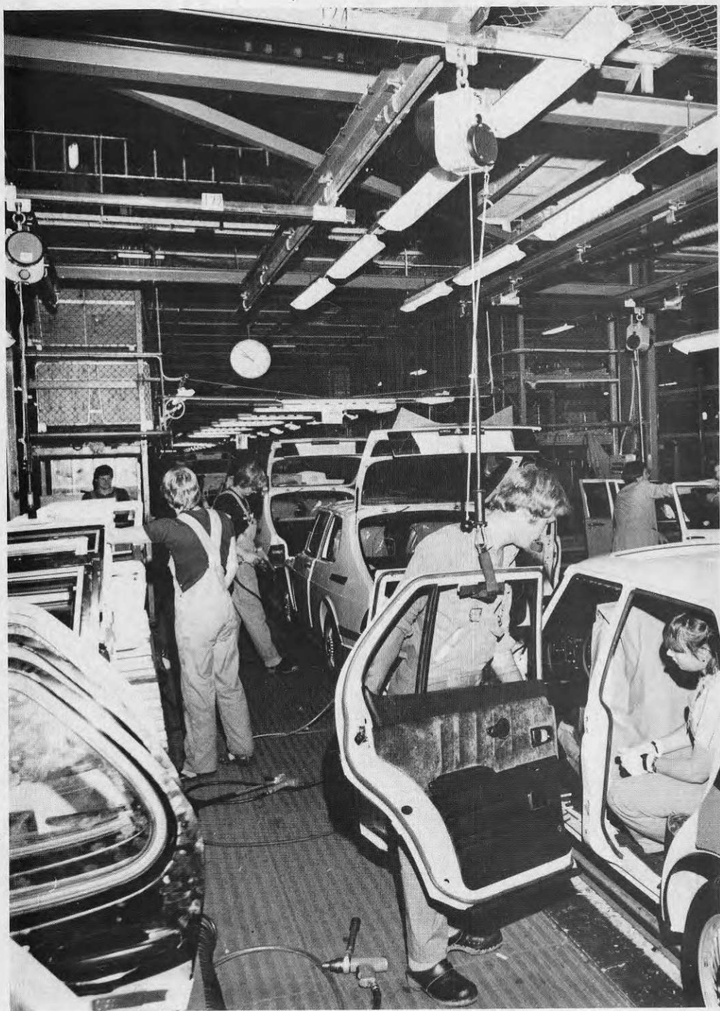
Figur 34. Balansblock monterat i taket. Arbetsredskapet eller utrustningen - i detta fallet en bildörr - blir "viktlöst" och lätt att hantera om det hänger i balansblocket.
