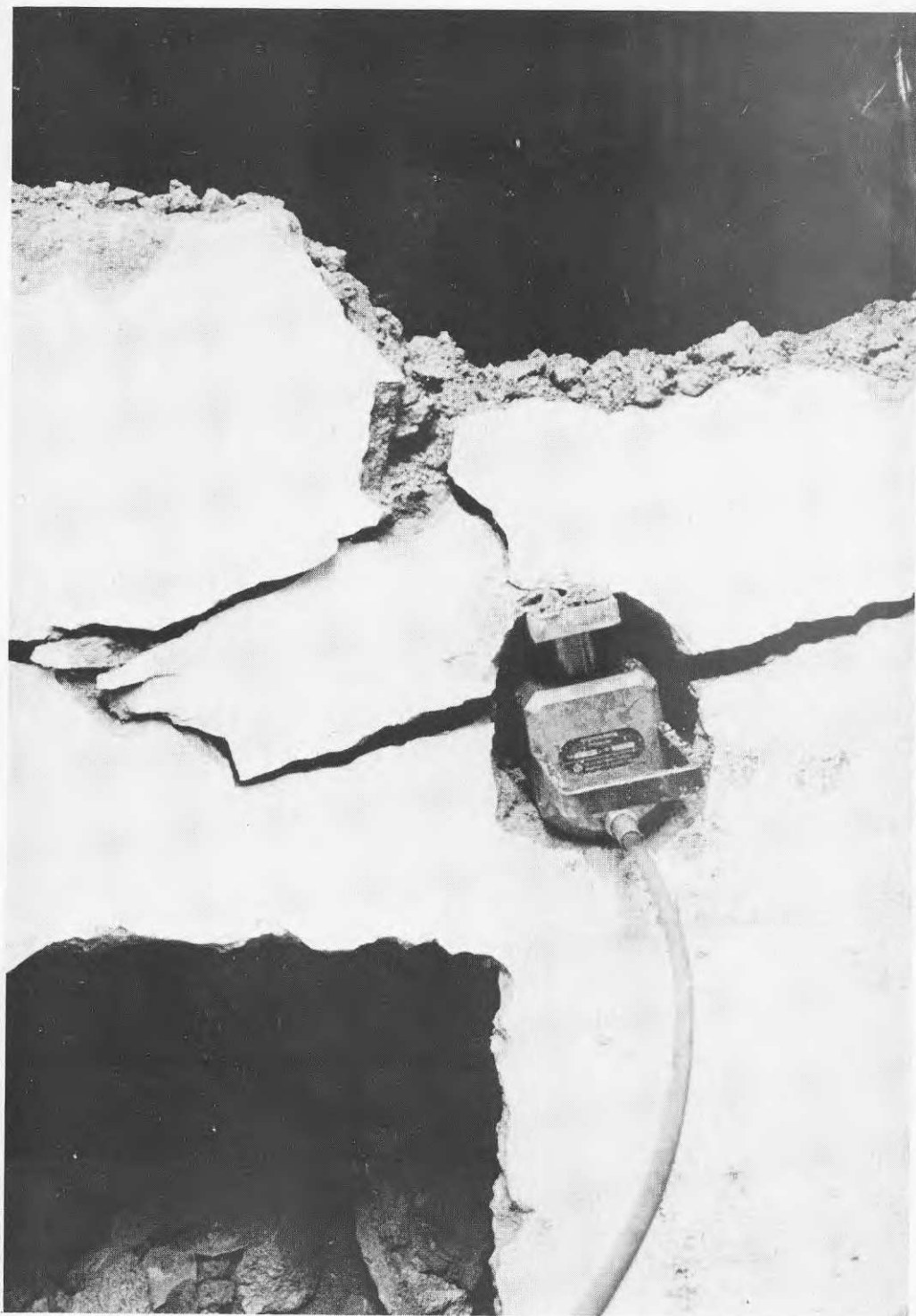
Figur 18 d) Spräckcylinder med utpressade kolvar.
